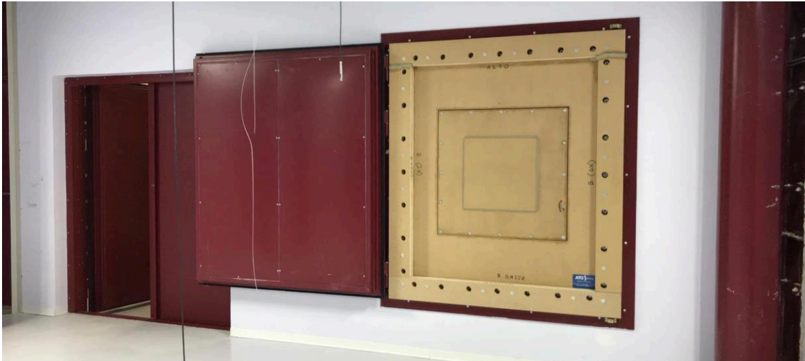
Figura 3.35: Configurazione di misura con tappo in legno.
