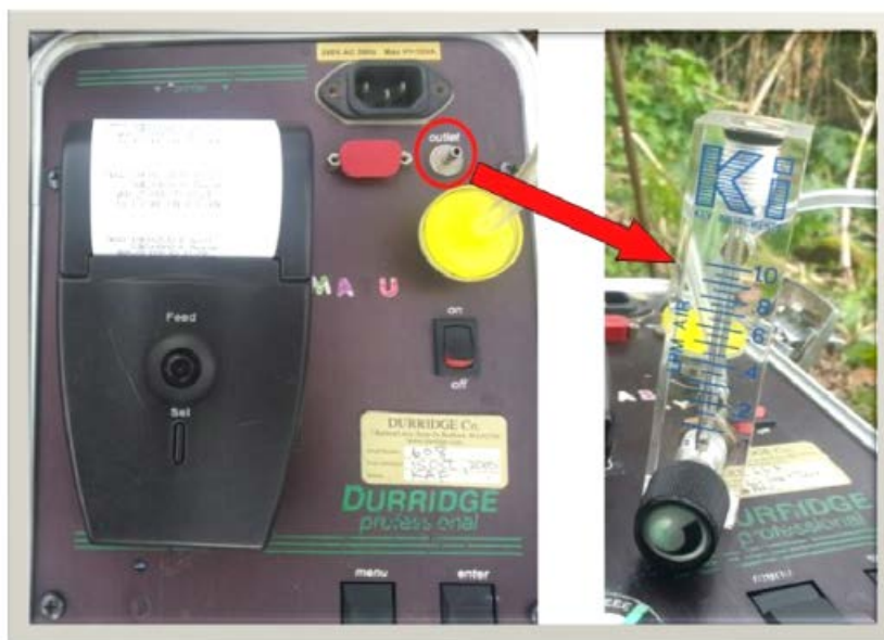
FIGURA 3.5 - Determinazione della portata della pompa RAD7 attraverso il collegamento del flussimetro alla valvola dell'outlet.
