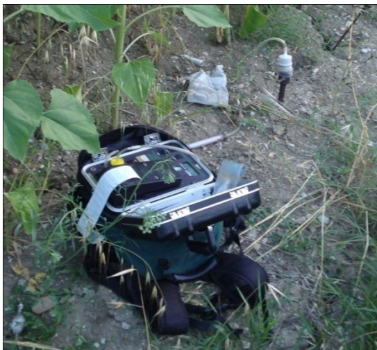
FIGURA 3.3 – Strumento per la misura del radon del suolo.
