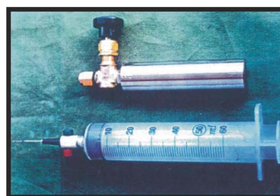
FIGURA 3.2 – Siringa, rubinetto e bomboletta in acciaio inox .
