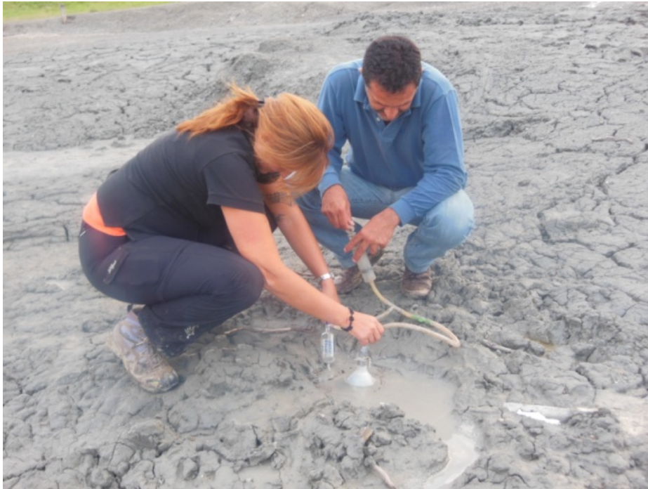
FIGURA 3.7 – Immagine della tecnica utilizzata nel campionamento del gas libero sulle emissioni gassose.
