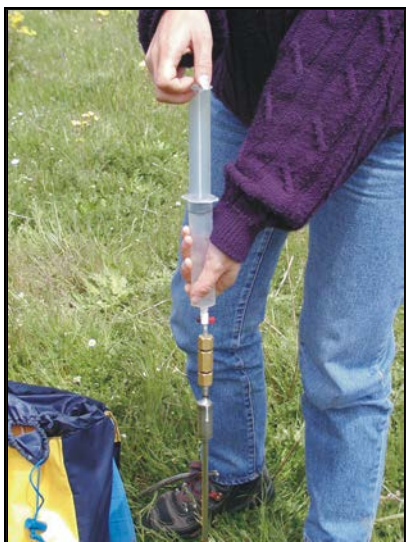
FIGURA 3.1 - Estrazione dei gas del suolo dalla sonda.
