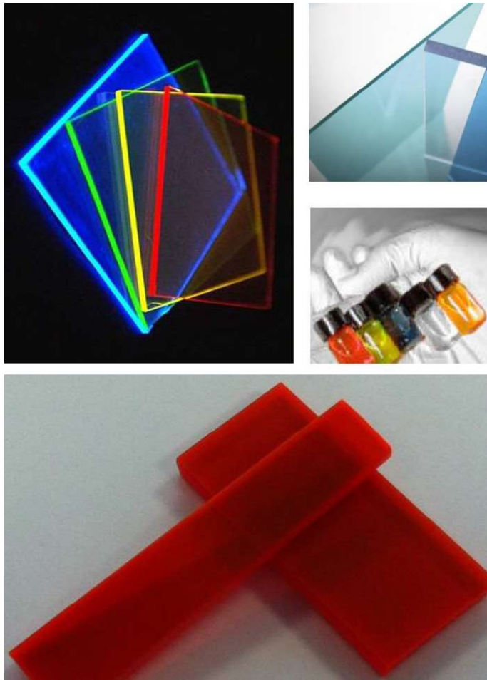
Fig. 5.5 – La matrice transparent (PMMA) et les colorants des LSC
