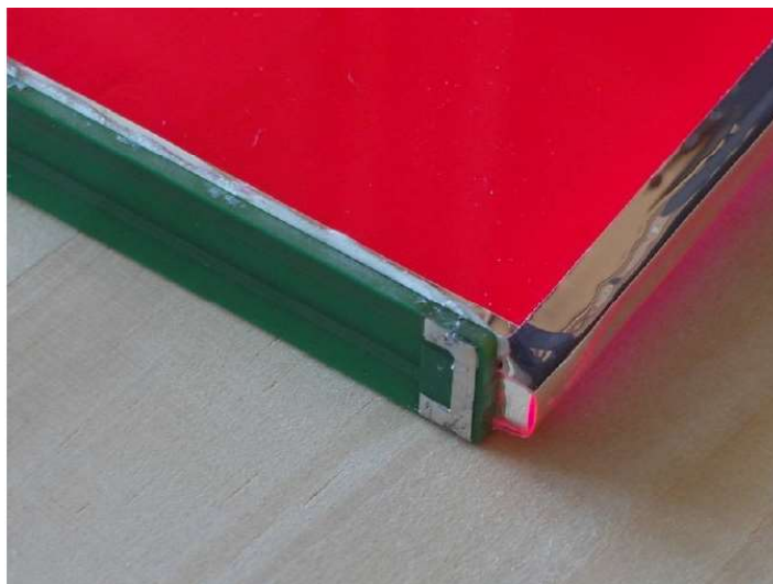
Fig. 5.6 – Un détail montrant le bord d'une plaque LSC équipée des récepteurs et d'un film réfléchissant sur les bords latéraux [15]
