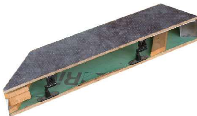
Fig. 4.11 – Panneau OSB avec feuille d'aluminium micro-foré
