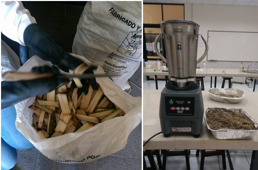
Figure 2.4 lavorazione delle Raquies di Banana: Sinistra corte delle raquies di banana. Strumento giusto per molatura fibra di Banano
