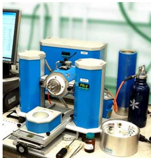
Figure 2 40 [Superiore] andamento modulo conservativo ( E' ), dissipativo ( E'' ) e smorzamento ( \tan \delta ) in temperatura. [Inferiore] Strumento DMTA - Dynamic Mechanical Thermal Analysis
