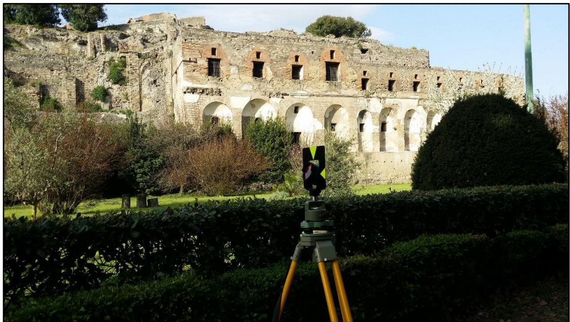
Figura 8.7 – Prima riflettente sul vertice Z 081
