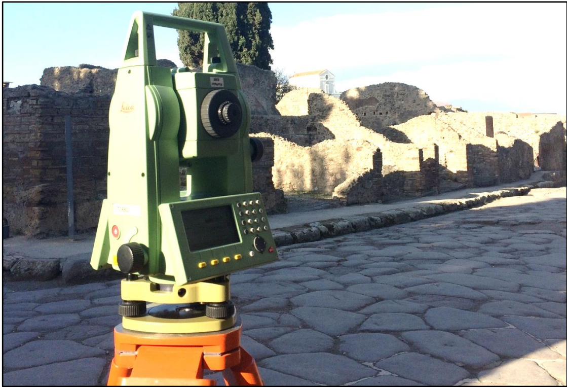
Figura 8.6 – Stazione totale sul vertice ST 045
