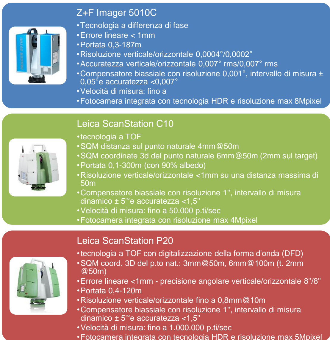
Figura 7.17 - TLS muniti di compensatore
