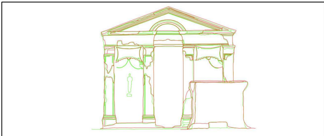
Figura 7.15 - Confronto tra la restituzione del prospetto da nuvola di punti TLS (rosso) e PhotScan (verde)
