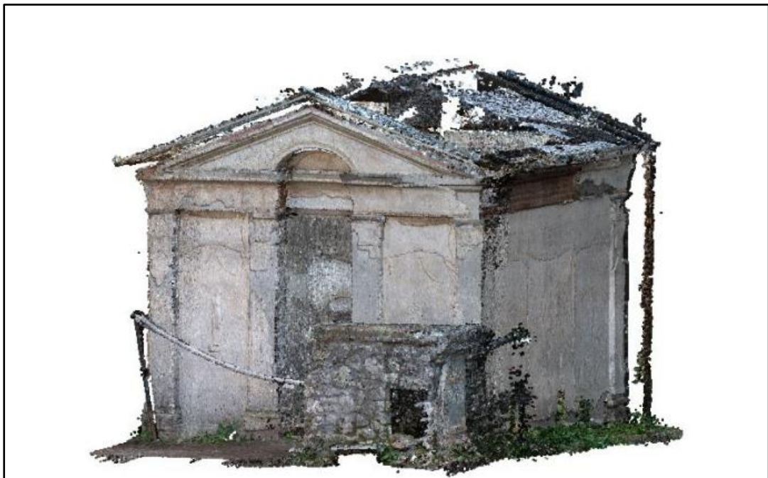
Figura 3.23 – PhotoScan: allineamento delle chunk a formare il modello 3D
