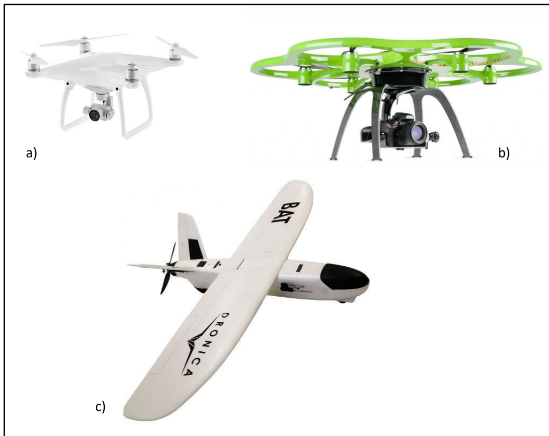
Figura 3.26 – a) un quadricottero Phantom 4, b) un esacottero Aibotix X6, c) un ala fissa Bat-1
