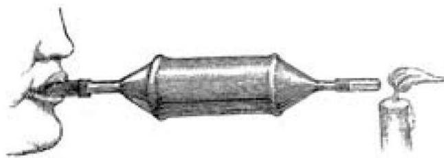
Fig. 1.38 – Les tests de Pettenkofer sur la porosité des matériaux [116]
