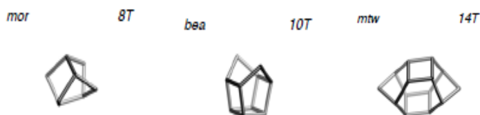
Figura3.18: Composite Building Units nella zeolite Beta
