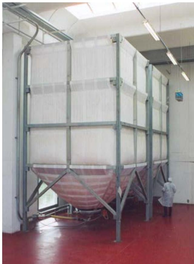
Figura 1. Esempio di silo flessibile con sacco in tessuto e struttura di supporto in acciaio (immagine tratta dal sito <http://agriflex.it>).
