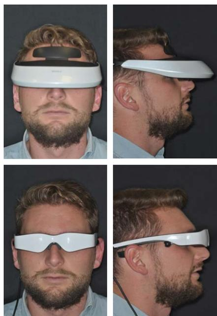
Figura 1. Confronto tra il modello Sony HMZ-T2 Head Mounted Display (in alto) e il modello Carl Zeiss Cinemizer 3D Oled Display (in basso).
