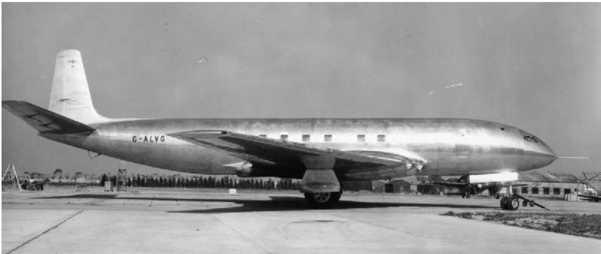
Figura 2-1: Nel 1950 gli aerei avevano i finestrini quadrati, questa geometria provocava una concentrazione di tensione troppo elevata e ne causava la rottura in volo
