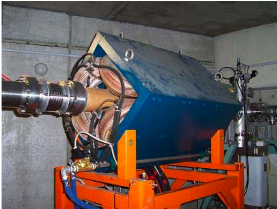
Figura 2.4: Quadrupolo magnetico lungo la linea del fascio primario di ^{18}\text{O} .
