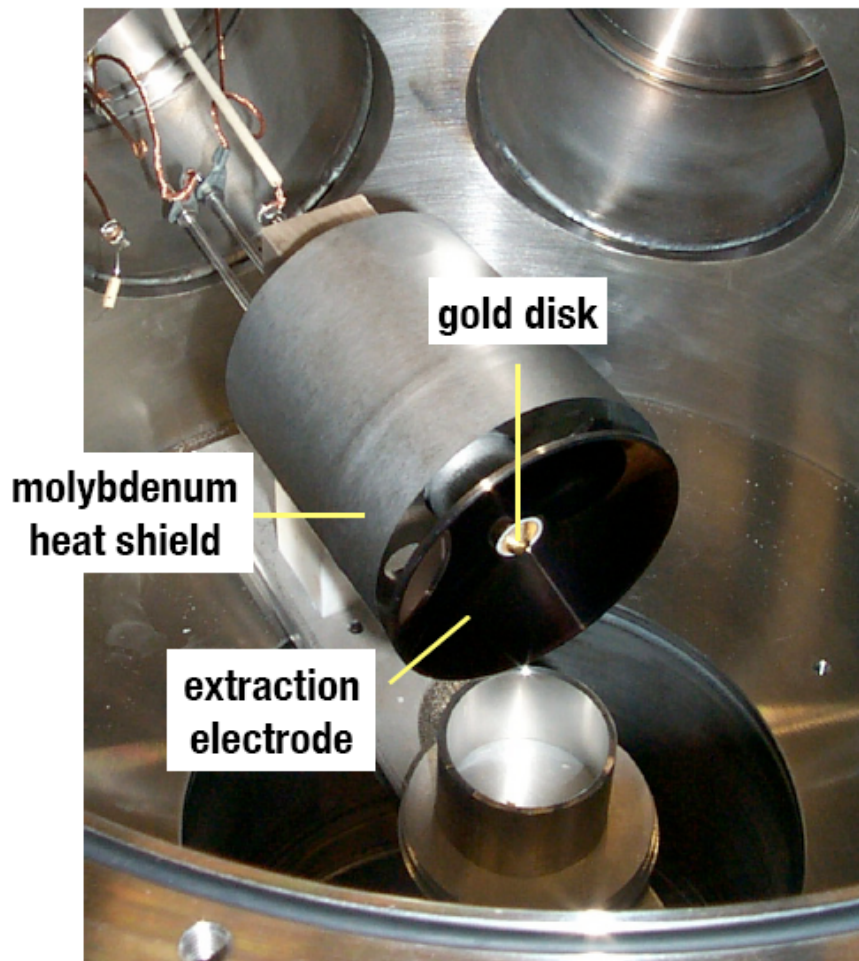
Figura 2.7: Il bersaglio d'oro e l'elettrodo di estrazione.
