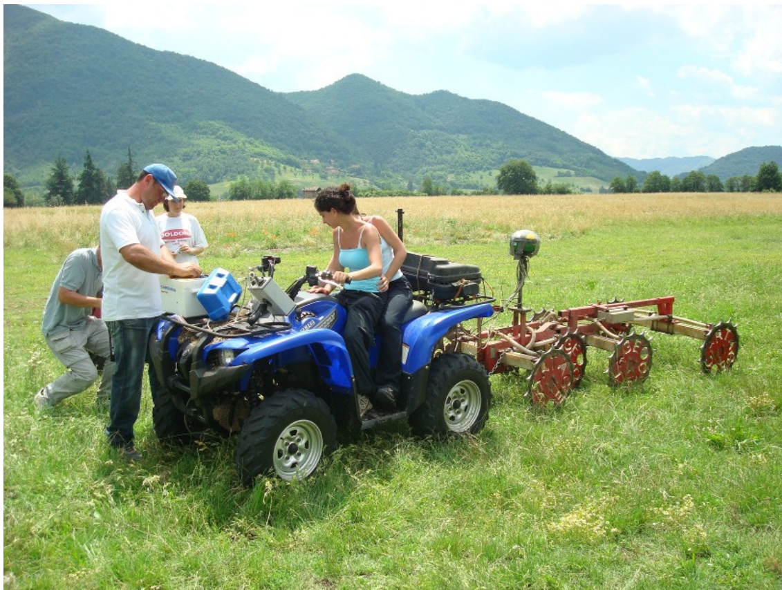
Fig. 1.15 – Il sistema di acquisizione ARP ® .
