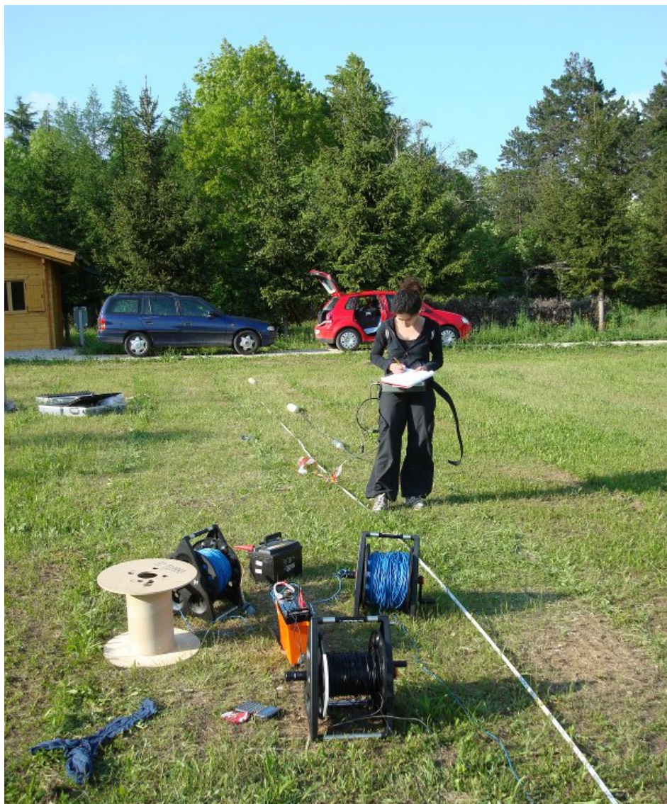
Fig. 3.6 – Acquisizione dei profili con l'OhmMapper nell'Area Test del Museo Civico di Rovereto. A sinistra dell'operatore è possibile notare l'attrezzatura utilizzata per realizzare i profili con il georesistivimetro ad accoppiamento galvanico Terrameter SAS1000.
