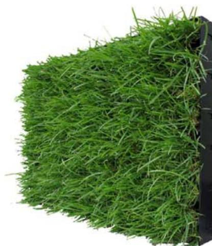
Particolare di una cassetta Tecology. Allo scopo di sfruttare ai fini della stabilità del sistema l'abbondante apparato radicale orizzontale dei tappeti erbosi, si sono studiate per queste cassette delle apposite buccature che oltre a consentire la percolazione di acqua tra gli alveoli, permette agli stoloni delle piante di formare all'interno del pannello un unico sistema intrecciato
