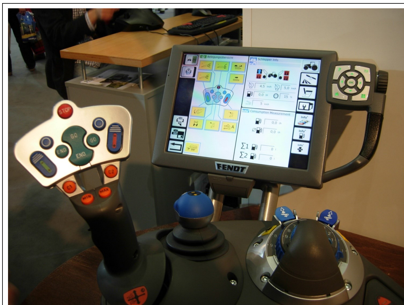
Figura 3.4 Auxiliary input montati su plancia completa di Virtual Terminal, su cui è visualizzata la schermata di assegnazione Auxiliary Input - Auxiliary Function
