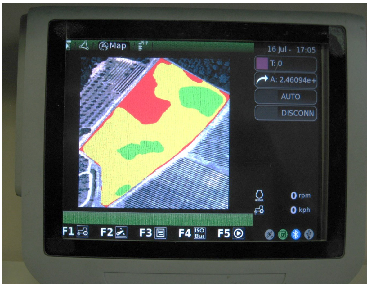
Figura 3.5 - Esempio di task controller sviluppato per SAME, con mappa di prescrizione per defogliazione su vigneto
