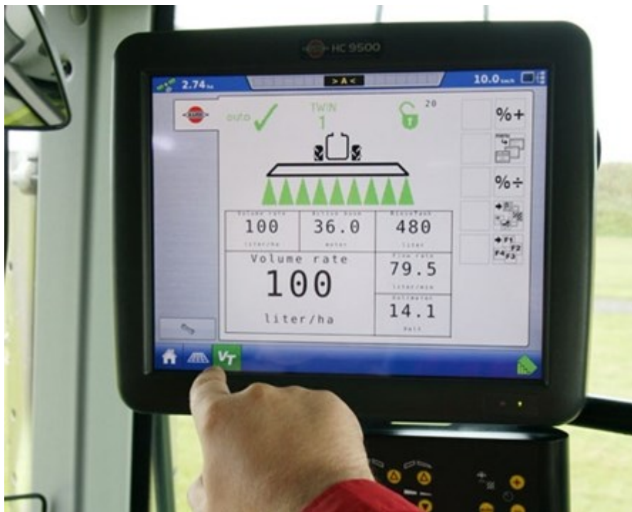
Figura 3.3 - Esempio di Virtual Terminal che visualizza l'Object Pool di uno sprayer
