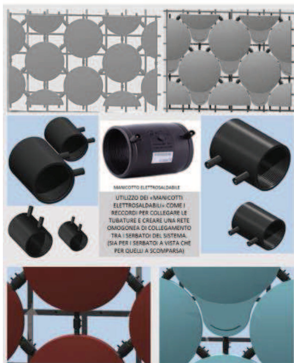
Fig. 30 La dimostrazione della modalità di collegamento tra le tubature dei serbatoi del sistema tramite i raccordi/manicotti "Elettrosaldabili" (sia per i serbatoi a scomparsa che quelli a vista)
