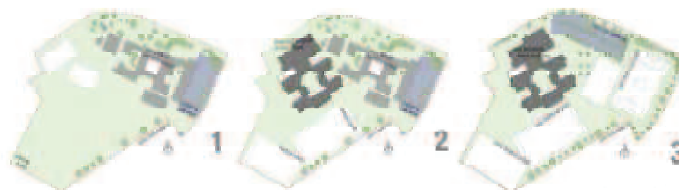
Figura 38 in questo esempio la progettazione del sito viene sviluppata per fasi. Questa operazione consente di affinare le scelte sull'uso dello spazio esterno, sulla relazione con gli ambienti interni della scuola, sull'orientamento, i percorsi esterni e la disponibilità e collocazione delle attrezzature. (Fonte: CABE)
