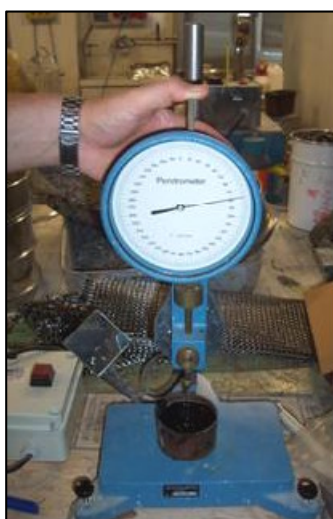
Foto 5.10 - Esecuzione della prova di penetrazione
