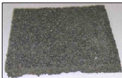
Foto 3.2 – Provini quadrati e circolari per prove meccaniche ed acustiche
