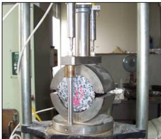
Foto 5.4 - Prova Marshall, provino giunto a rottura per schiacciamento
