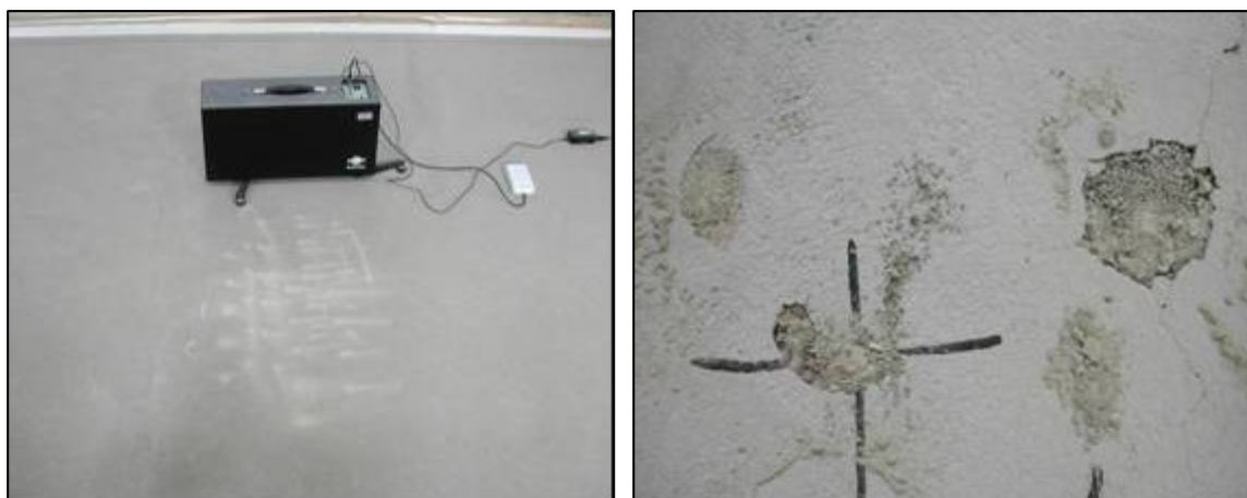
Foto 3.7 - Effetti degli impatti dei martelli della macchina di calpestio su un massetto di prova
