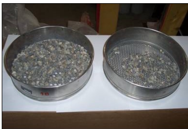
Foto 5.8 - Pietrisco di pezzatura 1,5 cm trattenuto da crivelli da 10 e 5 mm
