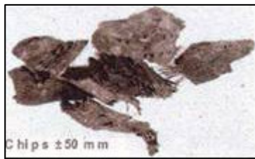
Foto 2.5 – Chip di pneumatico frammentato meccanicamente (circa 10-50 mm)
