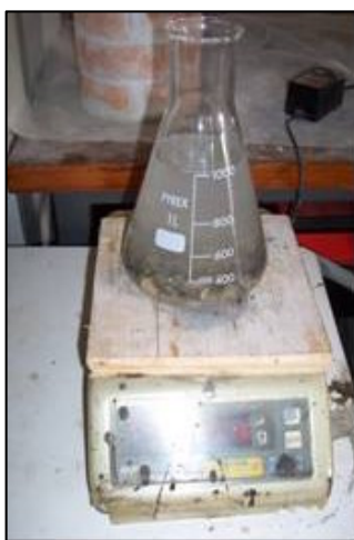
Foto 5.9 - Misura del peso del picnometro contenente aggregato da 1,5 cm e acqua distillata
