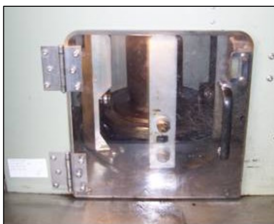
Foto 5.3 - Compattazione per mezzo di pressa giratoria Superpave Giratory.
