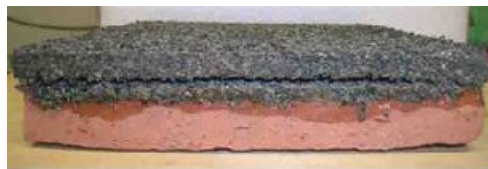
Foto 3.1 – Posa di materiale e provino realizzato con granuli di PFU
