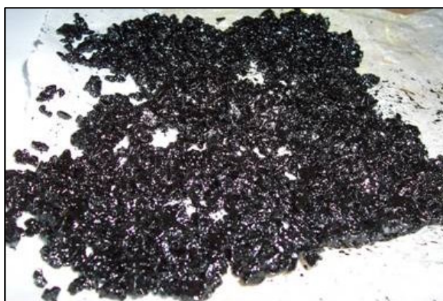
Foto 5.6 - Materiale Asphalt Rubber nella fase di raffreddamento a temperatura ambiente
