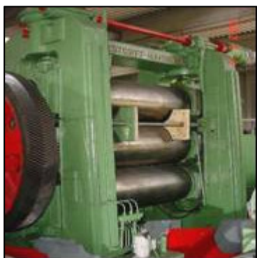
Foto 1.6 - Calandra a 3 rulli e Sri-Lanka, produzione della gomma
