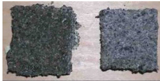
Foto 3.4 – Deformazione provini dopo prova meccanica di compressione
