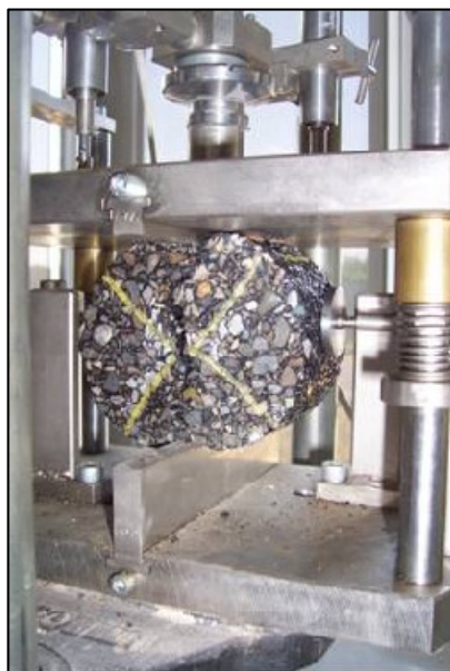
Foto 5.7 - Rottura del provino n° 1 sottoposto alla prova brasiliana
