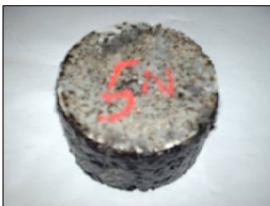
Foto 5.5 - Provino Marshall sottoposto al test della densità secondo norma CNR N°40-73
