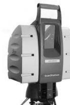
rilievo laser scanner a tempo di volo
