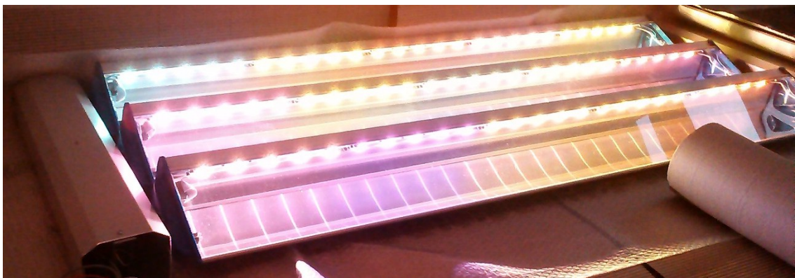
Figura 2.56 Moduli Solar FLight RGB durante i test in laboratorio.
