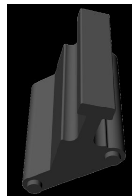
Figura 2.37 Disegno CAD in Rhinoceros del setto oscurante e posizionamento sul PCB.
