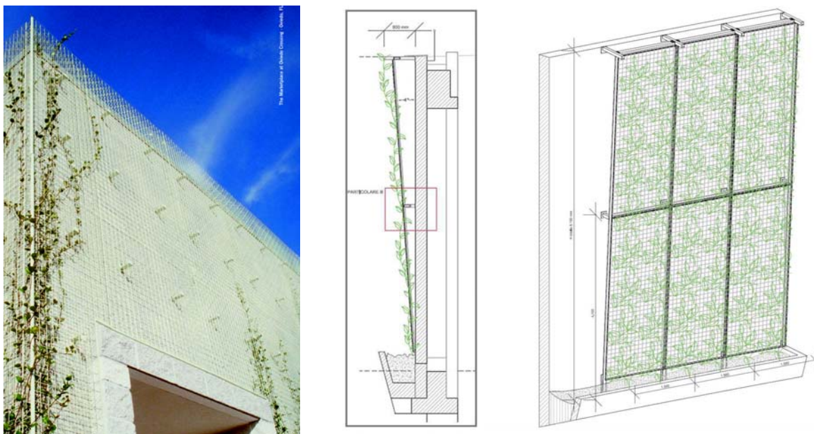
Fig.III.101 – A sinistra. Pannello modulare Greenscreen . Consiste in un elemento metallico grigliato di forma parallelepipedica per il supporto di specie rampicanti. Esso è integrabile a qualsiasi tipo di chiusura edilizia esistente o di nuova edificazione mediante montanti metallici, tasselli, staffe, ecc. Può inoltre essere impiegato in modalità freestanding tramite appositi supporti verticali. (Fonte: catalogo Greenscreen )
