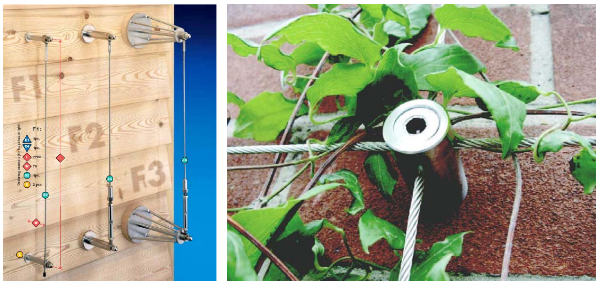
Fig.III.48 – A sinistra. Sistema di supporto in cavi tesati di acciaio inox senza montanti orizzontali. La conformazione verticale lo rende particolarmente idoneo per piante a sviluppo volubile. Alle estremità dei cavi sono visibili diversi elementi di ancoraggio e tendicavo, fissati a muro mediante tasselli chimici: essi hanno anche la funzione di distanziare adeguatamente le propaggini fogliari dalla superficie edilizia retrostante. (Fonte: catalogo Jakob Inox Line )
