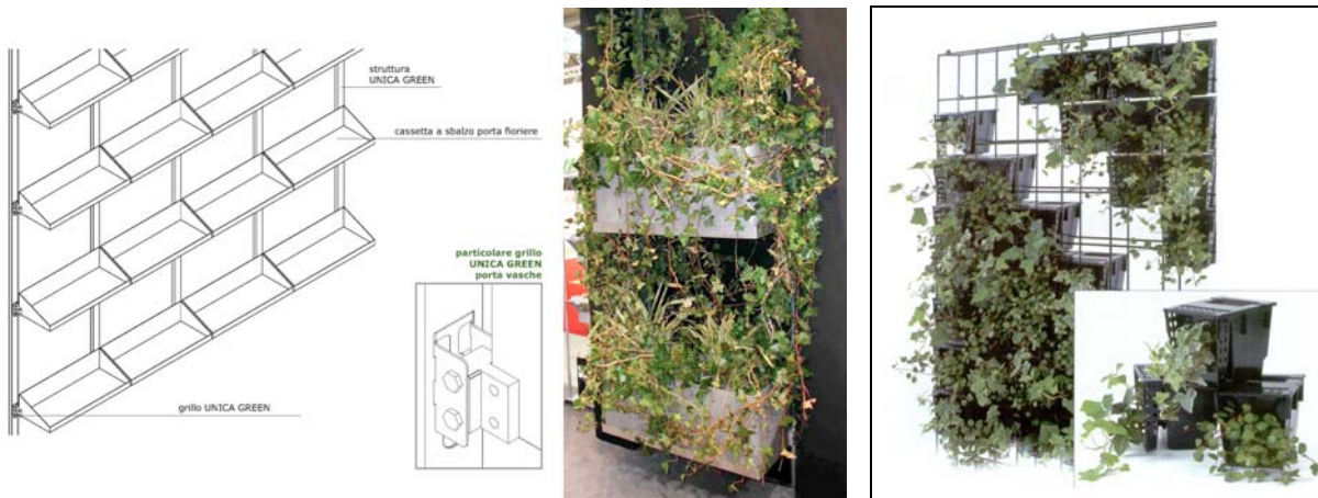
Fig.III.110 – A sinistra. Unica Green Flower Box prodotto da Designering . Sistema metallico prefabbricato contenente delle vasche che fungono da fioriere per la messa a dimora di specie a portamento decombente, fiori o arbusti di piccole dimensioni. Il sistema è completato da un impianto d'irrigazione e drenaggio. (Fonte: catalogo Unica )
