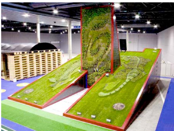
Fig.VII.23 – Luis de Garrido, GreenBox : prototipo di edificio realizzato in occasione della fiera Construmat , Barcellona (Spagna), 2009. Questa sperimentazione si pone l’obiettivo d’indagare nuove forme di edificazione sostenibile, sia dal punto di vista costruttivo-tecnologico che della fruibilità interna. Come visibile dalla foto di sinistra gli involucri risultano quasi completamente vegetati mediante l’impiego combinato di tecnologie per l’inverdimento pensile e parietale. La conformazione esterna del manufatto risulta pendente, così che la copertura possa porsi in continuità col paesaggio naturale circostante. A destra un’assonometria che illustra il sistema costruttivo realizzato in C.A. prefabbricato e acciaio per le strutture in elevazione, e legno per le coperture. (Fonte: http://www.arquimaster.com.ar/galeria/obra101_green_box.htm#planos )
