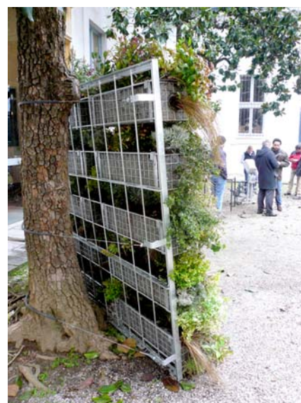
Fig.V.54 – A sinistra. Modulo mobile per la realizzazione di muri vegetali indoor , prodotto dall’azienda Verdecrea . Nella parte bassa, contiene un serbatoio per il recupero della soluzione idrosalina non trattenuta dalle piante, che potrà così essere re-immessa in circolo mediante il sistema di fertirrigazione a circuito chiuso. Il prezzo commerciale di questo sistema si attesta mediamente sui 450-600 €/m 2 .
