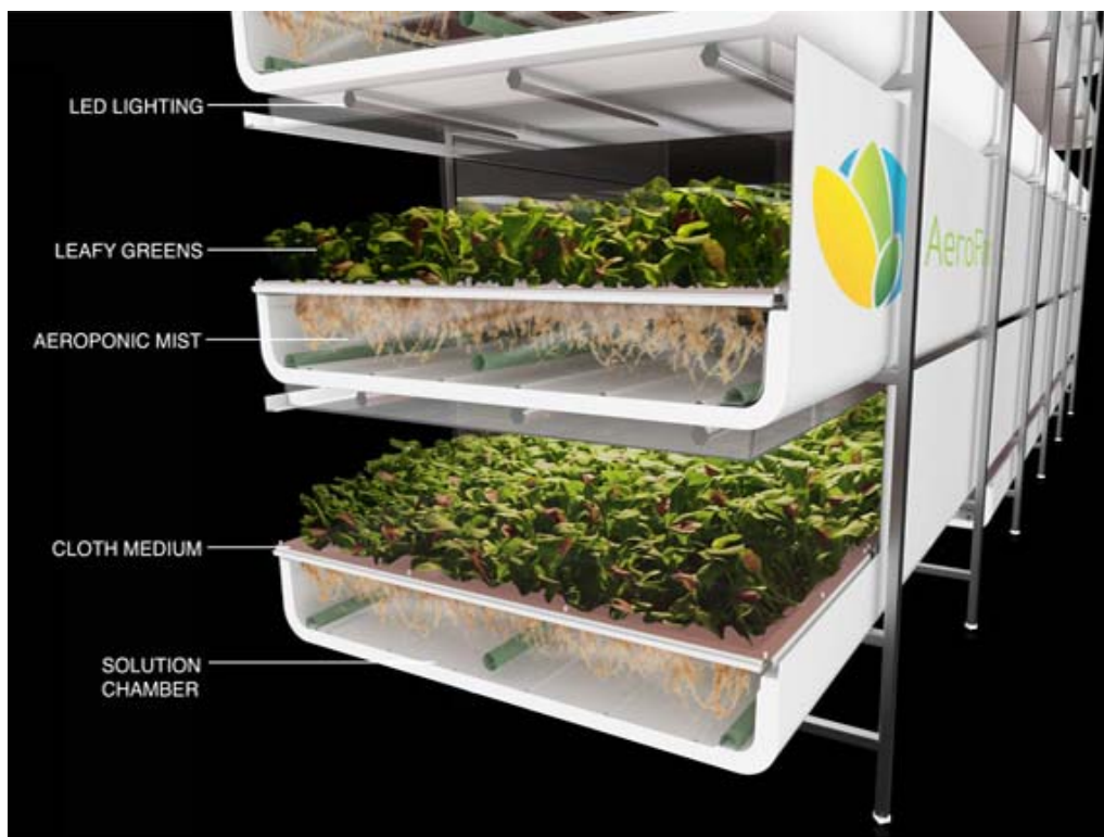
Fig.VII.82 – AeroFarms, schema del funzionamento di un banco di coltivazione aeroponica in ambiente indoor. Le piante vengono coltivate senza terreno e con le radici libere, mediante l'ausilio di un sistema di scaffalature multipiano: un apposito sistema di fertirrigazione automatizzata provvede a fornire più volte al giorno (mediante vaporizzazione) la soluzione idrosalina per il nutrimento dei vegetali. L'energia luminosa necessaria alle attività biologiche delle piante è fornita mediante un sistema di lampade infrarosse. La tecnica della coltivazione idroponica è una di quelle che, in futuro, permetterà la concretizzazione del Vertical Farming . (Fonte: http://aerofarms.com/why/technology )
