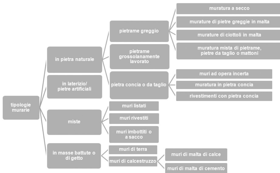
Fig. 4.5 Classificazione delle murature secondo Daniele Donghi
