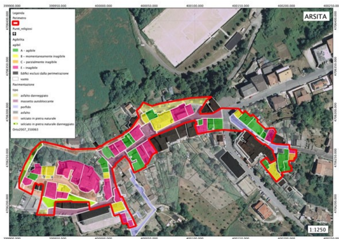
Fig. 1.13 Perimetrazione dell'area d'intervento del Comune di Arsita (TE) ed esiti di agibilità (CTR, Ortofoto_Volo_2007 e dati AeDES: ENEA - C. R. Bologna)
