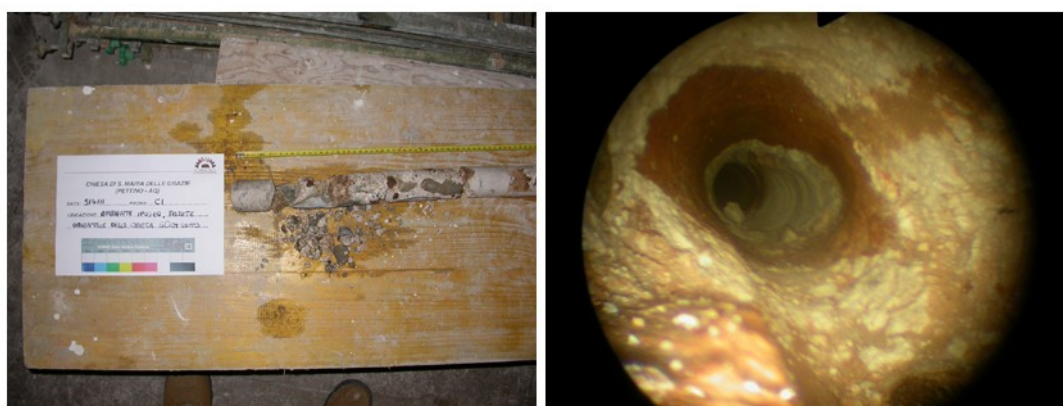
Fig. 6.17 Carotaggio 1 a destra dell'ingresso principale (Fotografie: Il Cenacolo S.r.l.)
