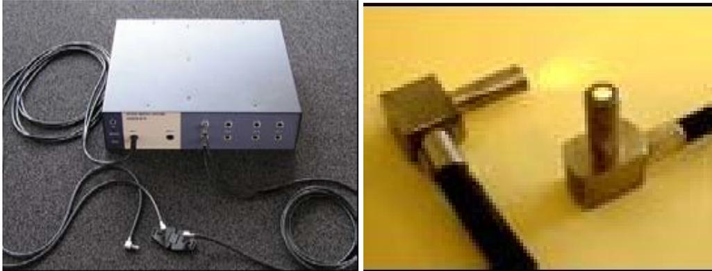
Figura 2. Spettroscopia a raggi infrarossi OxyMon MK III e diodi laser.
