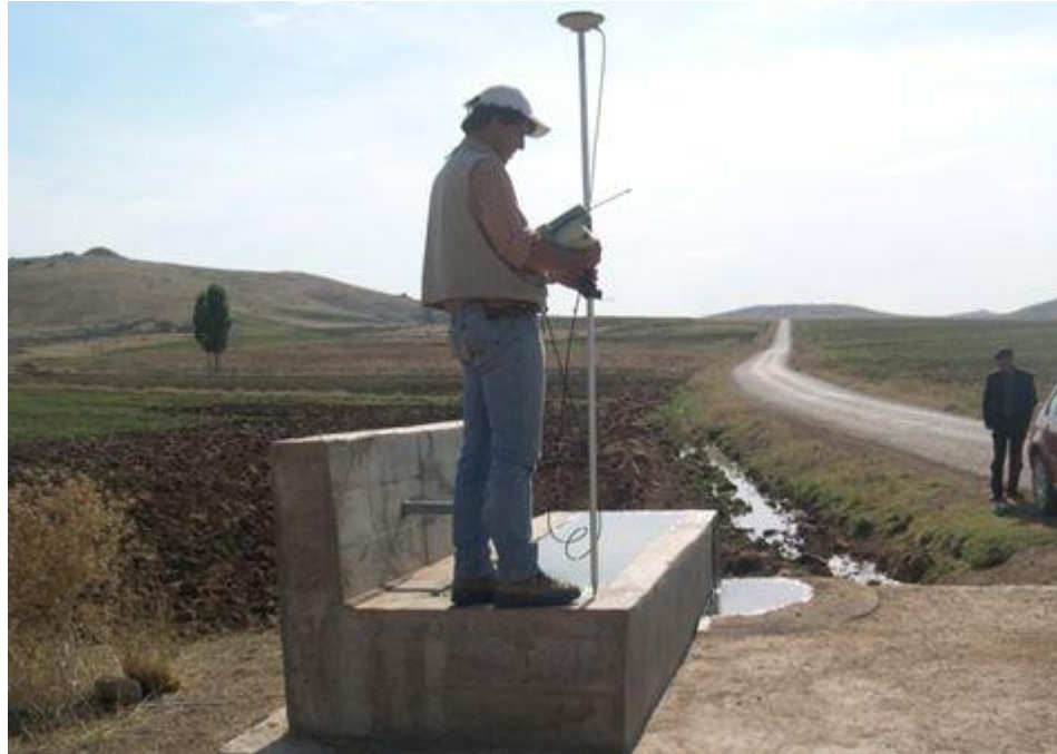
Fig. 4.5. Rilevamento punti GPS: parte strutturale di una fontana ad elevato contrasto radiometrico "acqua/cemento" riconoscibile nell'immagine satellitare grazie all'alta risoluzione spaziale (50 cm)
