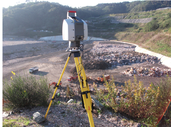
Fig. 55: rilevamento con TLS geomorfologico presso la discarica di Scarpino (GE)
