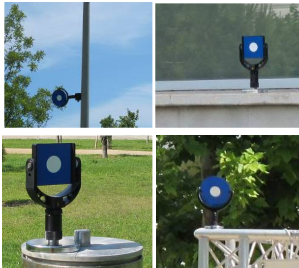
Fig. 72: posizionamento targhet artificiali per il rilievo
