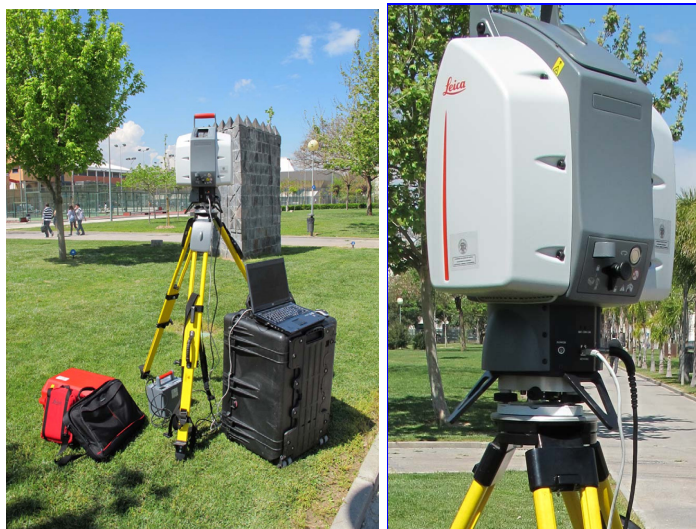
Fig. 7: Laser Scanner Leica ScanStation2: acquisizione dati
