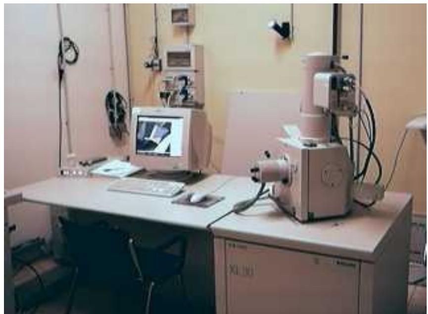
Fig. 3.4.2 – Microscopio a scansione elettronica SEM XL-30 presso il Centro Interdipartimentale Grandi Strumenti dell'Università di Modena.
