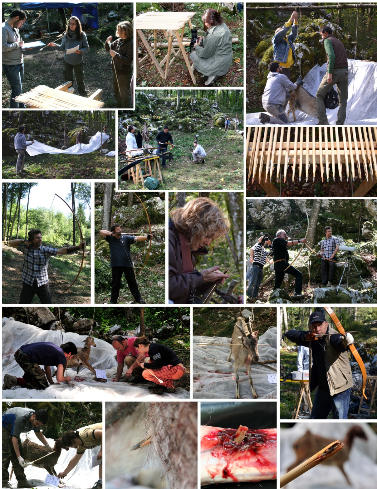
Tav. VIII – Schema rappresentativo delle attività svolte nella seconda fase della sperimentazione: predisposizione dell'area di raccolta dei frammenti, fissaggio della carcassa, misurazione delle distanza di tiro, misurazione del libbraggio effettivo dell'arco, documentazione preliminare delle frecce, documentazione dei dati balistici durante la sessione di tiro (penetrazione del proiettile, stato frammentario delle armature), recupero dei microliti mediante la macellazione della carcassa.
