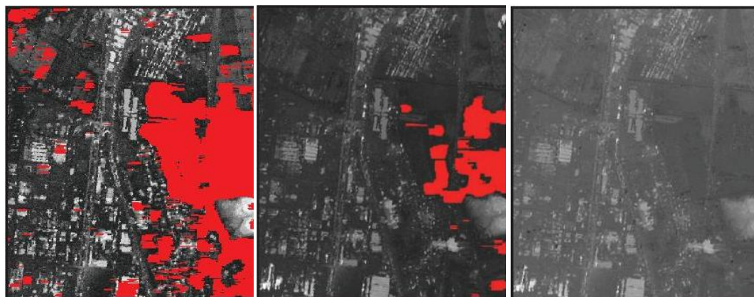
Figura 5-15 – IKONOS II: confronto tra le aree di No data (indicate in rosso) per DSMs ottenuti con diversi valori di quota limite
