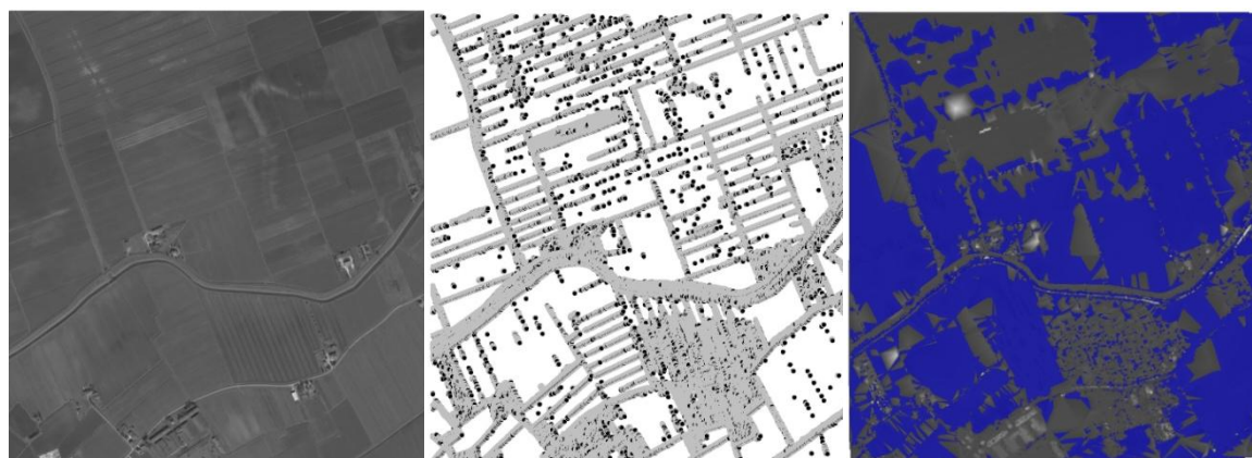
Figura 6-32 - GeoEye-1: immagine satellitare (sinistra), punti estratti durante il matching con SISAR (centro) TIF finale per il tile rurale (destra)
