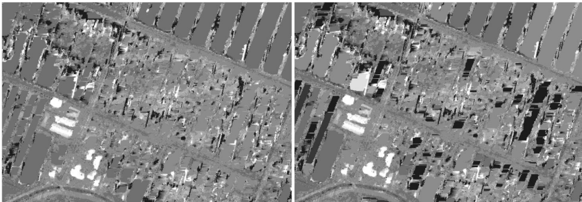
Figura 6-29 - GeoEye-1: fill con ArcMap: tool automatico (sinistra) e procedura manuale (destra): si nota un andamento analogo delle due tecniche, con valori più dipendenti da errori nel matching di OrthoEngine per quanto riguarda la procedura manuale
