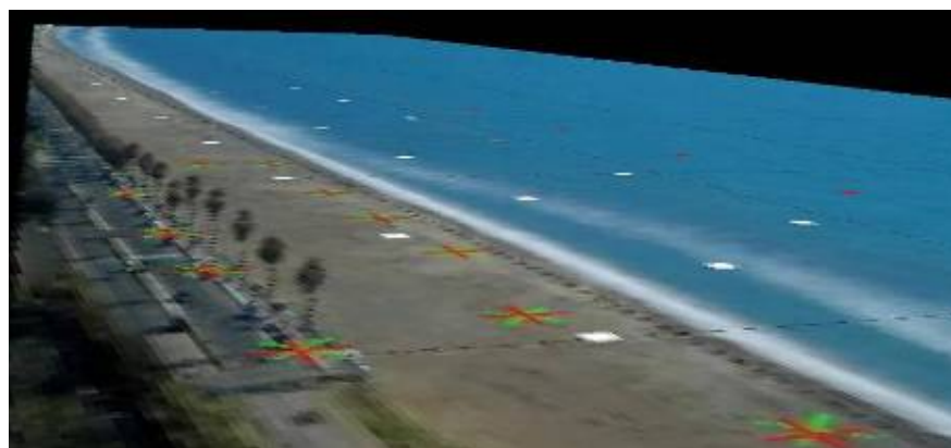
Figura 3.3.7. – Andamento del pixel footprint in funzione della prospettiva. Tramite una funzione inversa è stata trasformata un'immagine piana nella sua versione prospettica. Sull'immagine piana erano stati disegnati dei quadrati bianchi 5m x 5m. Nella visione prospettica si capisce bene quanto una stessa porzione di territorio (quadrantini bianchi) sia rappresentata da un numero diverso di pixels in funzione della distanza dalla camera (e quindi della prospettiva).
