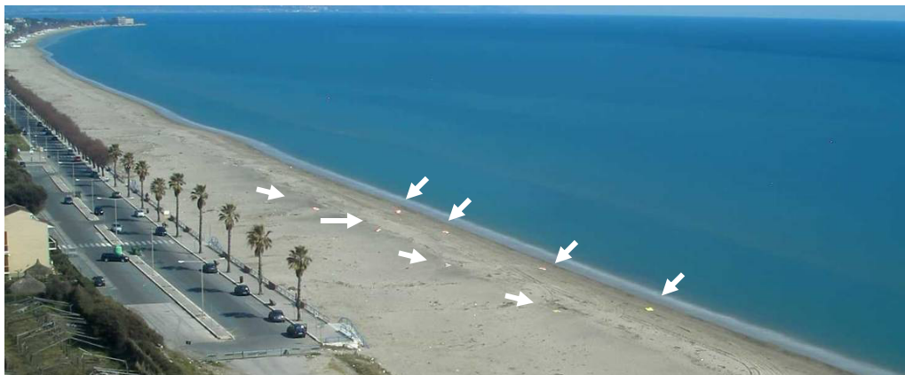
Figura 3.2.6. – Particolare della foto scattata in data 18 Febbraio 2009, in cui sono state posizionate delle mire graduate di 1m x 1m, evidenziate dalle frecce.
