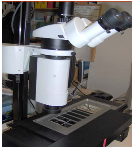
Figura 2.8: Microscopio ottico per la lettura dei rivelatori (U-Series Srl).
