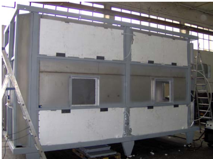
Figura 6.3: Parete “destra” della camera radon
