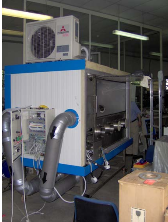
Figura 6.2: Camera di prova da 2 m 3 .
