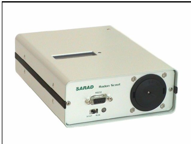
Figura 2.11: Monitor a semiconduttore “Radon Scout” Sarad.
