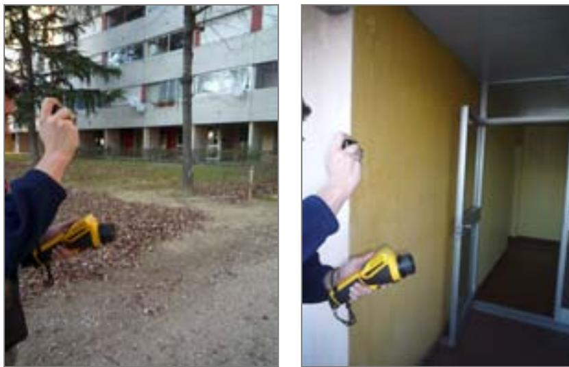
Figura 6.2 - Procedura di rilevamento con termocamera seguita al Virgolone.
