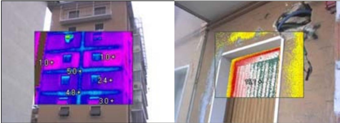
Figura 7.2 – Immagini termografiche del lato nord e di un particolare del fronte dell'edificio residenziale di Via Dalmazia, 60 di Bolzano. Studio tecnico Vettorim, Bolzano.
