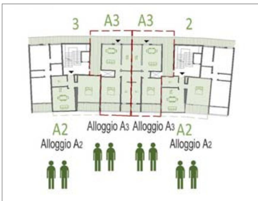
Figura 5.8. – Schema di aggregazione degli alloggi del piano primo nel Virgolone. Si notano i setti della struttura che identificano gli ambienti interni.
