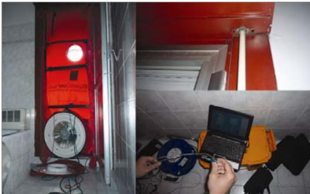
Figura - 6.1. Applicazione del Blower Door Test avvenuta nel mese di ottobre 2011 presso l'unità tipo A3 al piano primo del fabbricato Virgolone in Via Emilio Salgari, Bologna.
