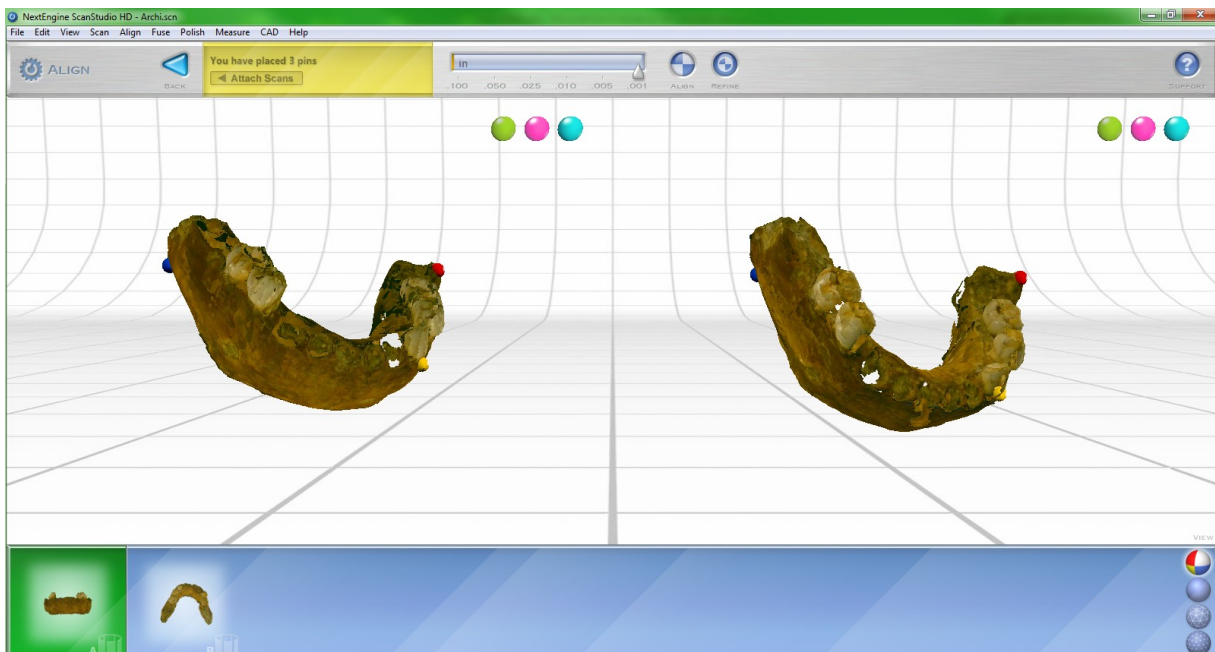
Figure 68: Alignement des deux séries de prises de vues à partir de trois points de repère. A gauche scan de la mandibule d'Archi en position verticale, à droite en position horizontale.
