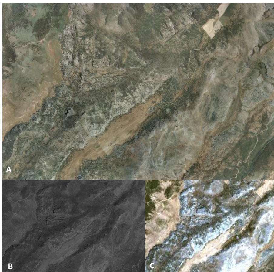
Fig.4.8 Immagini digitali rappresentative di una porzione dell'area di studio (settore centrale della Sierra de Libar): A) ortofoto aerea con risoluzione spaziale di 0,5 metri/pixel (Junta de Andalucía, 2006); B) banda 8 pancromatica Landsat ETM+ con risoluzione spaziale di 14,25 metri/pixel (1999); C) composizione delle bande Landsat ETM+ 3-2-1 (28,5 metri/pixel).
