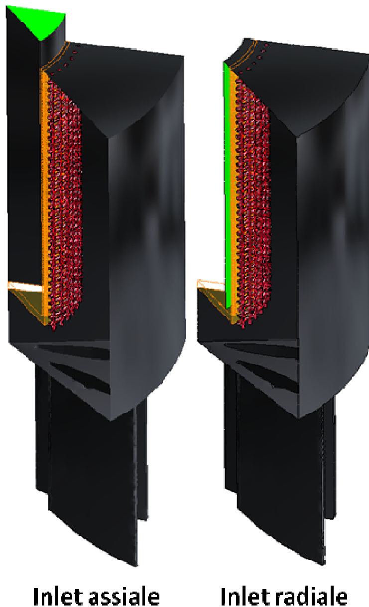
Fig. 10.76: Modelli geometrici implementati nelle analisi CFD. Settore assialsimmetrico con apertura di 45°
