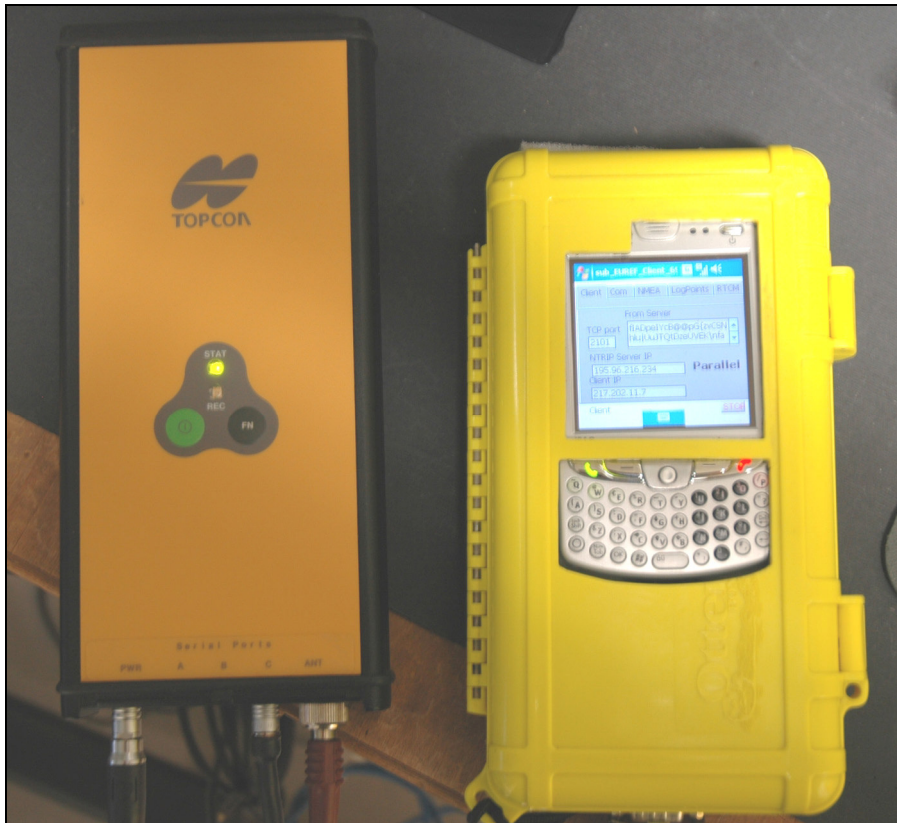
Fig. 2.26 Il ricevitore rover Topcon Legacy-E ( a sinistra) ed il palmare HP 6915( a destra). Nello schermo del palmare si nota il ClientNTRIP connesso alla rete SOGER
