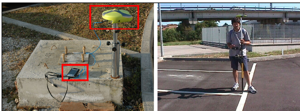
Fig. 3.11 La SemPeMuBaS nella prova esterna. A sinistra il Master-Server, a destra il Rover-Client.
