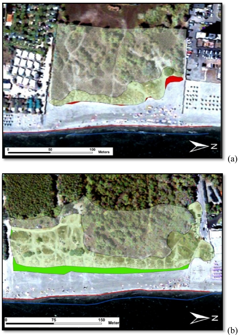
Figura 108 – Esempi di come la sovrapposizione di aree ricavate per un anno e per l'altro fornisca indicazioni sull'entità dell'avanzamento o dell'arretramento dei sistemi dunari. Per motivi di chiarezza dell'immagine, per entrambi i casi non si è riportato il confronto tra le aree di spiaggia, ricavate nello stesso identico modo.
