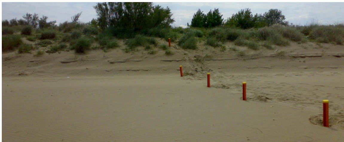
Figura 137 – Esempio di disposizione (array) di trappole sulla spiaggia.
