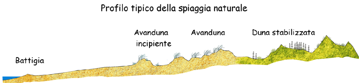
Figura 3 – Schema di un profilo tipico di un sistema spiaggia-duna in equilibrio, dove è possibile individuare tutte le forme tipiche della sequenza morfoevolutiva, da quelle effimere che nascono nella parte alta della spiaggia (avanduna) a quelle più stabili e consolidate più interne (duna stabilizzata).
