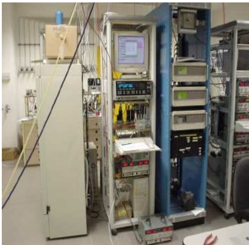
Figura 2.25: Apparato sperimentale per la spettroscopia ad impedenza.
