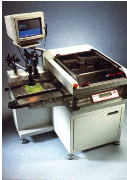
Figura 1.23: Macchina serigrafica impiegata per la deposizione del film sensibile sul supporto installata all'interno di una camera pulita onde evitare eventuali difetti produttivi dovuti ad impurità e microturbolenze ambientali.
