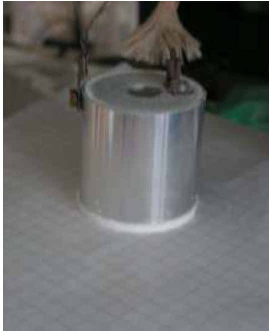
Figura 2.21: Condensatore cilindrico di misura in alluminio.
