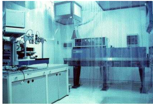
Figura 1.24: Interno di una delle camere pulite dell' LSS (Laboratorio Sensori e Semiconduttori) nelle quali avvengono le fasi del processo di lavorazione necessario per realizzare sensori di gas a film spesso con tecnologia serigrafica.
