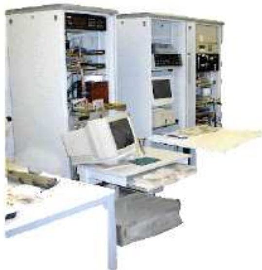
Figura 3.2: Fotografia dell'area dell' LSS (Laboratorio Sensori e Semiconduttori) occupata dai rack contenenti l'intero apparato sperimentale per la caratterizzazione elettrica.
