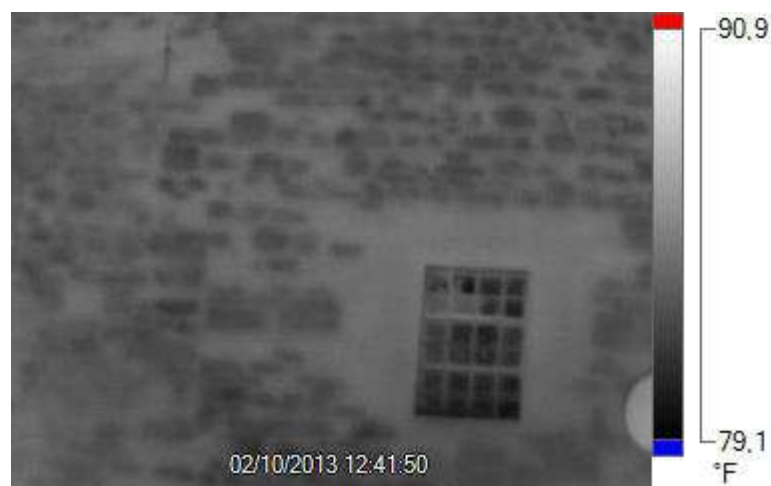
Immagine 64: immagine termica con elementi in mattone semipieni, elementi di sasso di fiume, elementi in mattoni pieni (contorno finestra) e filari di malta.
