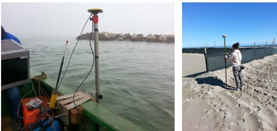
Figura 14: A sinistra una fase del rilievo GPS della spiaggia di Marina Romea e a sinistra una fase del rilievo batimetrico dei fondali di Casal Borsetti con tecnologia single beam.
