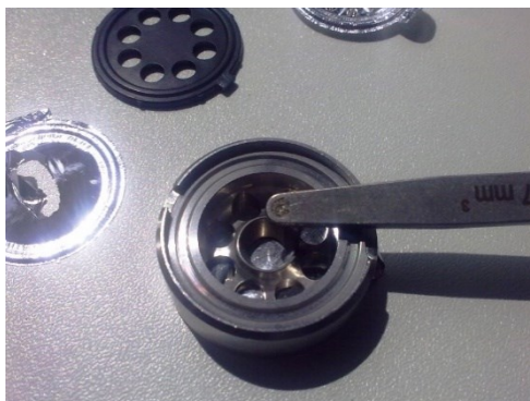
Figura 18: Una fase della preparazione del campione, con inserimento delle particelle all'interno del tappo a vite connesso alla campana di dispersione. In questo caso il volume di materiale analizzato è di 7 mm 3 .
