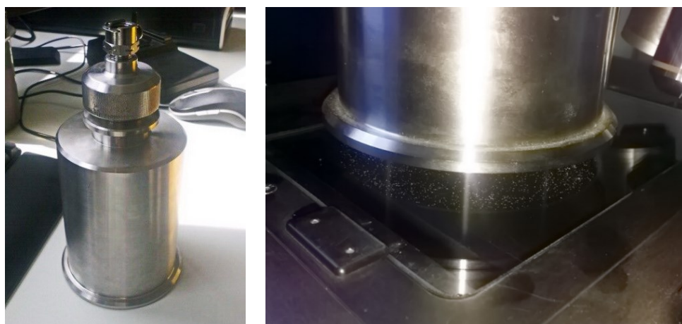
Figura 19: Campana per la dispersione del campione (a sinistra); particolare delle particelle disperse sul vetrino sotto la campana (a destra).
