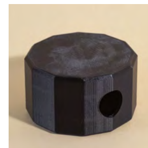
Prototipo realizzato in stampa 3D FDM.
