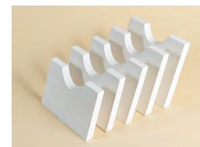
Modello di studio in PLA mediante stampa 3D FDM.
