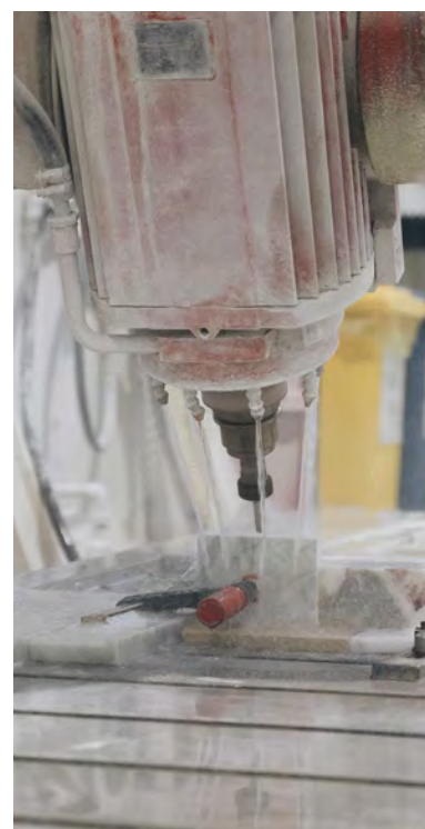
Produzione degli elementi tramite lavorazione CNC a 5 assi e finitura artigianale.
