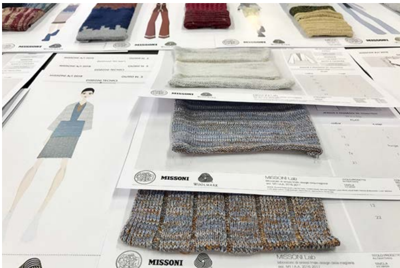
01 Tavole di progetto con figurini e prove teli con filati, tensioni, punti e colori definitivi per la realizzazione del capo
