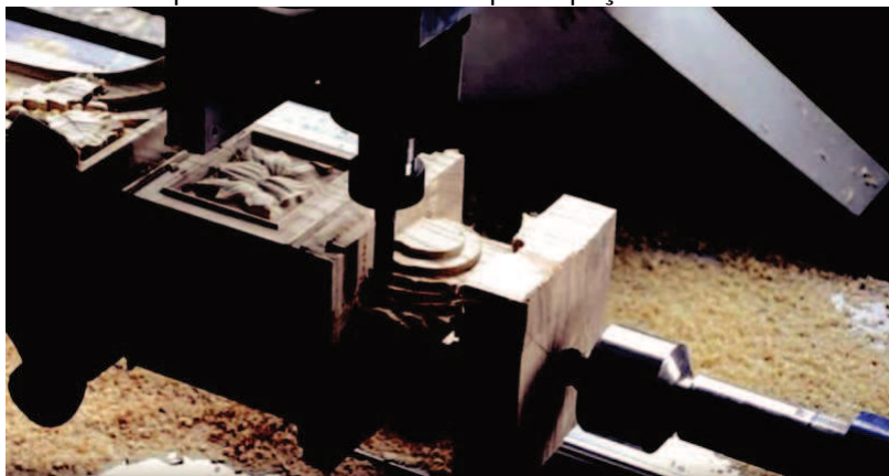
Figura 4.58 – Máquina fresadora 3D esculpindo peça ornamental em madeira.
