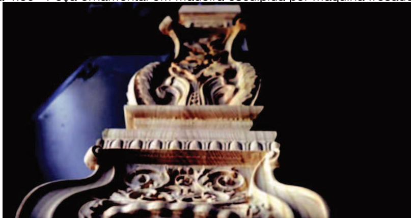
Figura 4.59 – Peça ornamental em madeira esculpida por máquina fresadora 3D.
