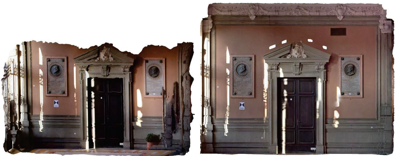
Figura 3.103. Comparação dos mosaicos resultantes do levantamento fotogramétrico da superfície do vestibulo. Modelo mesh com aplicação de textura e extração de ortofoto. À esquerda, campanha de fotografias com única tomada linear. À direita, campanha de fotografias em duas alturas lineares e inclinações horizontal e vertical.
