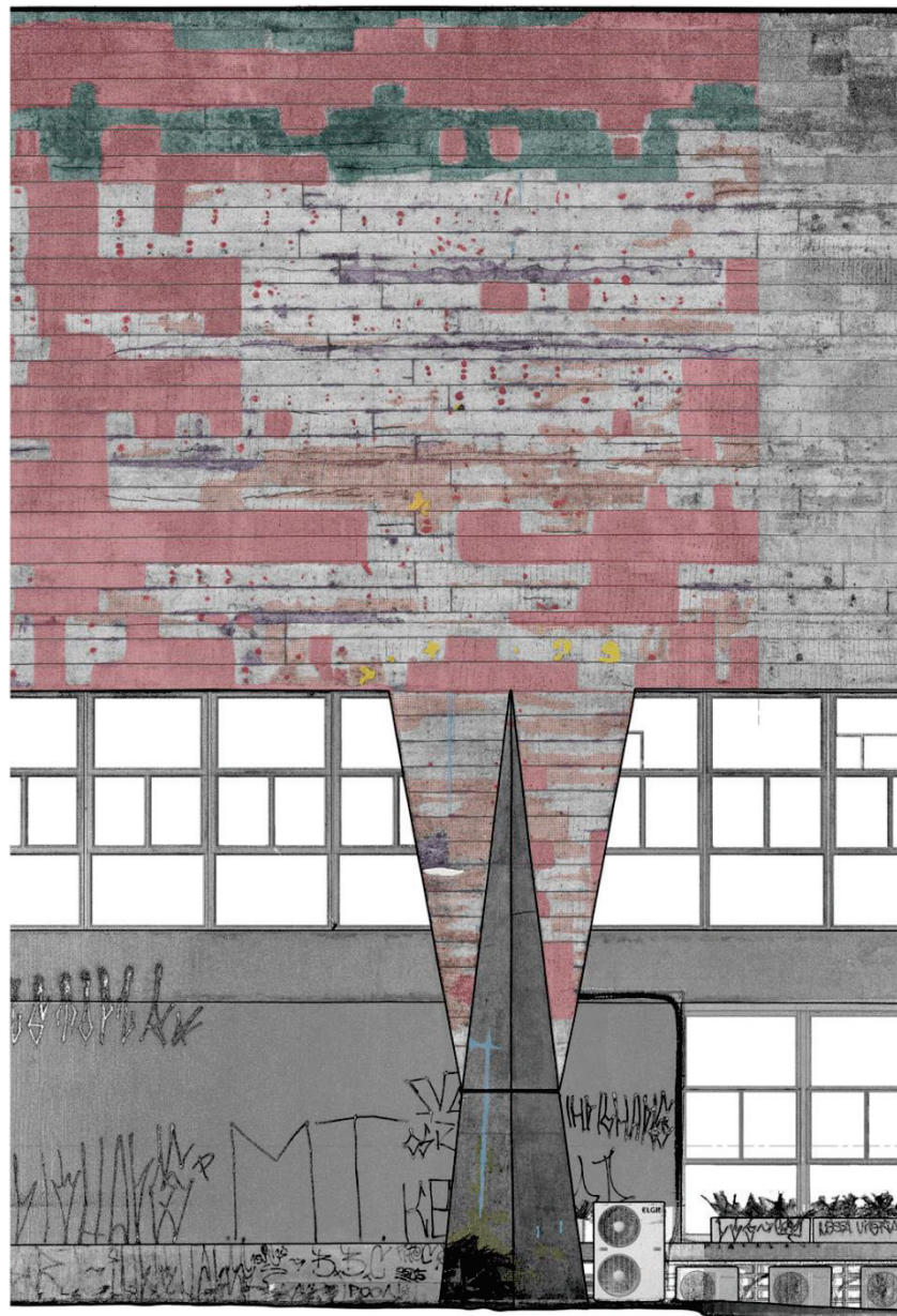
Figura 3.39. Mapeamento de danos sobre ortofoto de trecho representativo da empena sudeste do edifício. Abaixo, a legenda adaptada do relatório do DIAPReM considera a subdivisão entre morfologias de deterioração, à esquerda, e alterações características do concreto armado, à direita.
