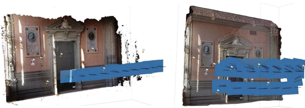
Figuras 3.100 e 3.101. Atividade de levantamento fotogramétrico de uma das superfícies do vestibulo. Comparação dos resultados obtidos a partir de diferentes estratégias de aquisição de dados.
