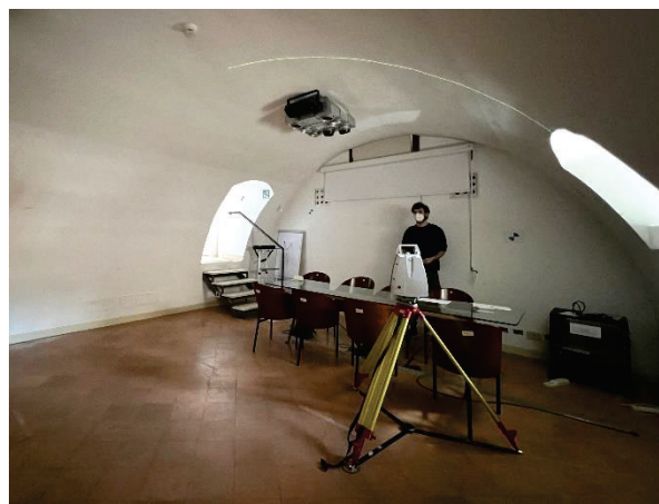
Figuras 3.82 a 3.86. Levantamento arquitetônico e urbano a partir de escaneamento a laser, realizado pelos pesquisadores do DIAPReM (Unife).
