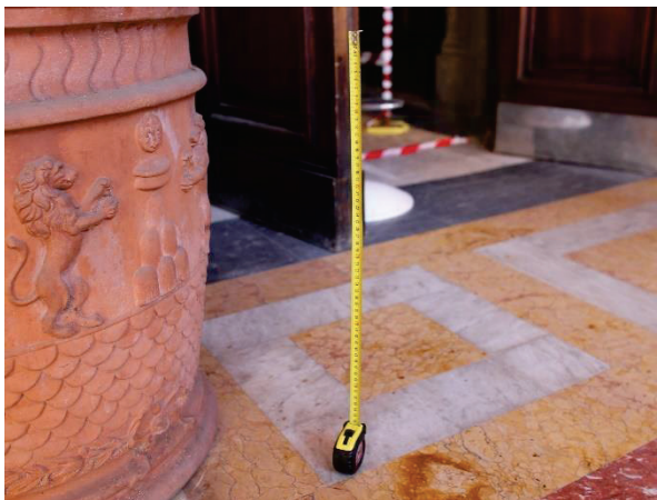
Figuras 3.93 e 3.94. Atividade de levantamento fotogramétrico de um vaso de cerâmica decorado. Utilização de uma trena como referência de escala métrica.
