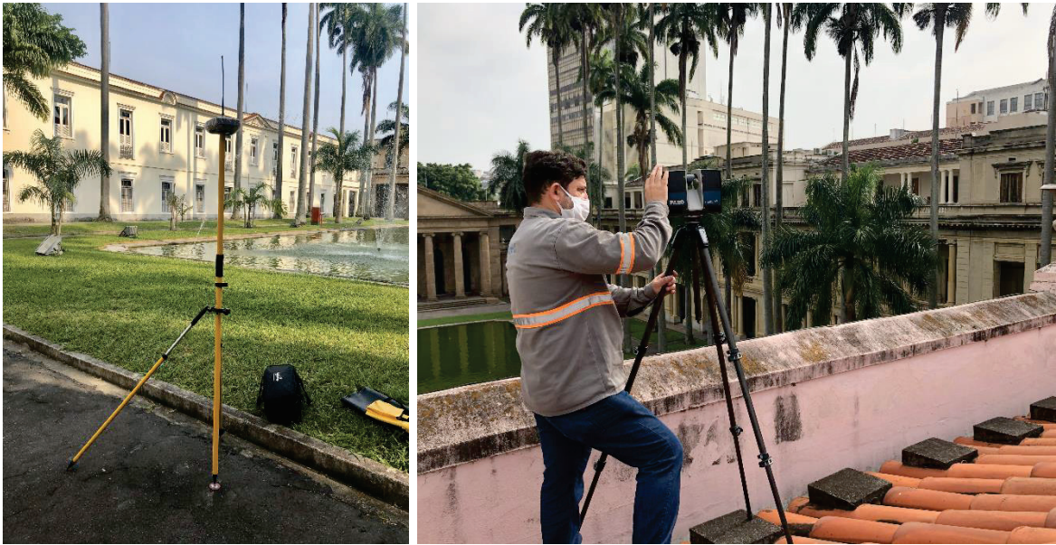
Figuras 3.56 e 3.57. Registro dos trabalhos em campo de levantamento métrico-arquitetônico do Complexo do Itamaraty. À esquerda, georreferenciamento de pontos de interesse com GNSS. À direita, escaneamento da cobertura do Palácio do Itamaraty com scanner terrestre.
