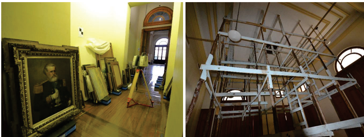
Figuras 3.20 e 3.21. Interferências na captura de dados pelo equipamento de escaneamento a laser: acervo nos corredores e estruturas de proteção de forros em algumas das salas do Museu do Ipiranga.
