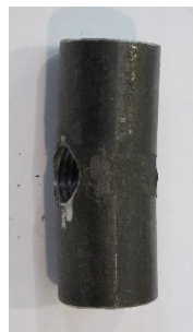
Fig. 4-4 Tipologia A con svaso. Modalità di rottura in trazione per provini: in LVL di abete (a, b, c) e in LVL di faggio (d, e, f). Connettori S355 al termine della prova (g,h,i). Distanza longitudinale dalla testa del provino a_1 = 100 mm (a, d, g), 150 mm (b, e, h) e 150 mm (c, f, i). Sezione trasversale B = 60 mm (a, b), 80 mm (c, d) e 100 mm (e, f).
