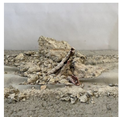
Fig. 6-9. Prove di taglio parallelo monotono su tasselli: modalità di rottura per provini con sezione trasversale B = 200 mm e tassello d = 12 mm
