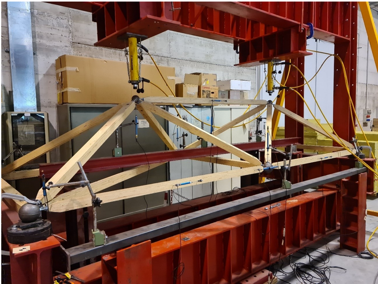
Fig. 4-10 Prove su prototipi reticolari spaziali: setup di prova
