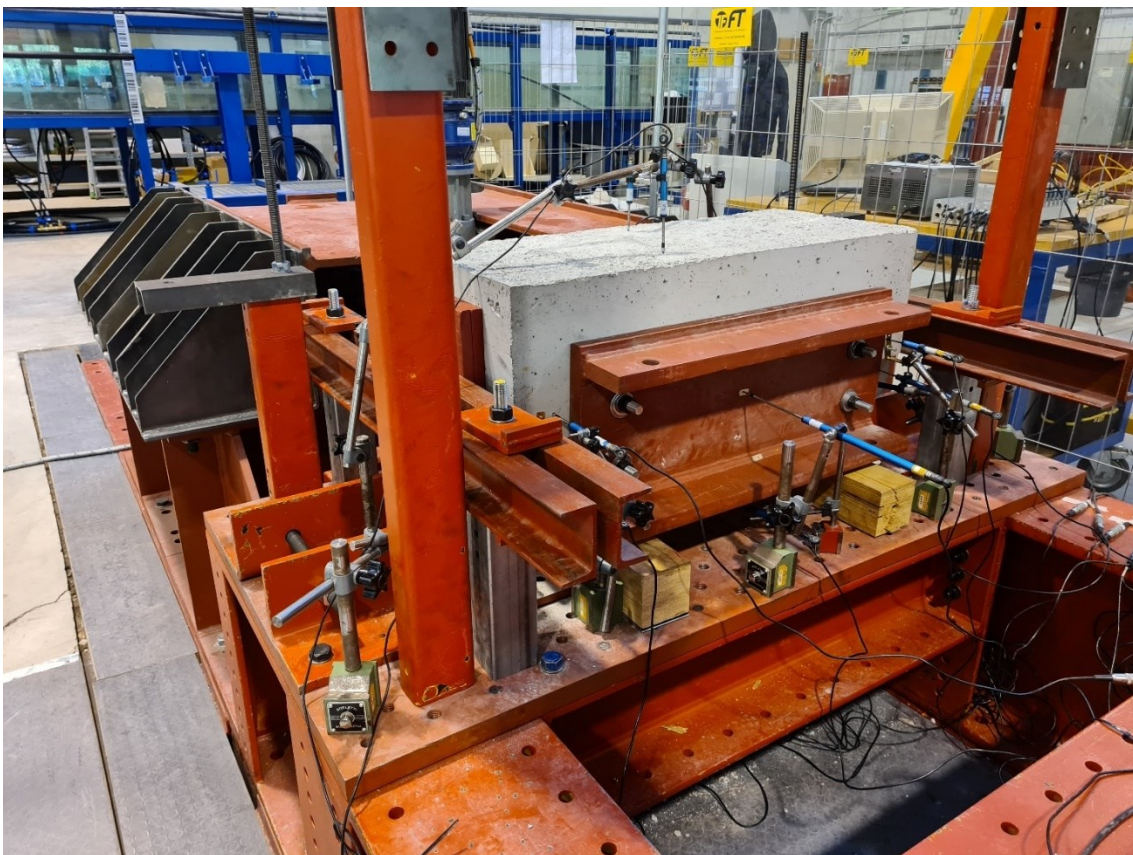
Fig. 7-1. Prove di taglio ortogonale: Setup di prova
