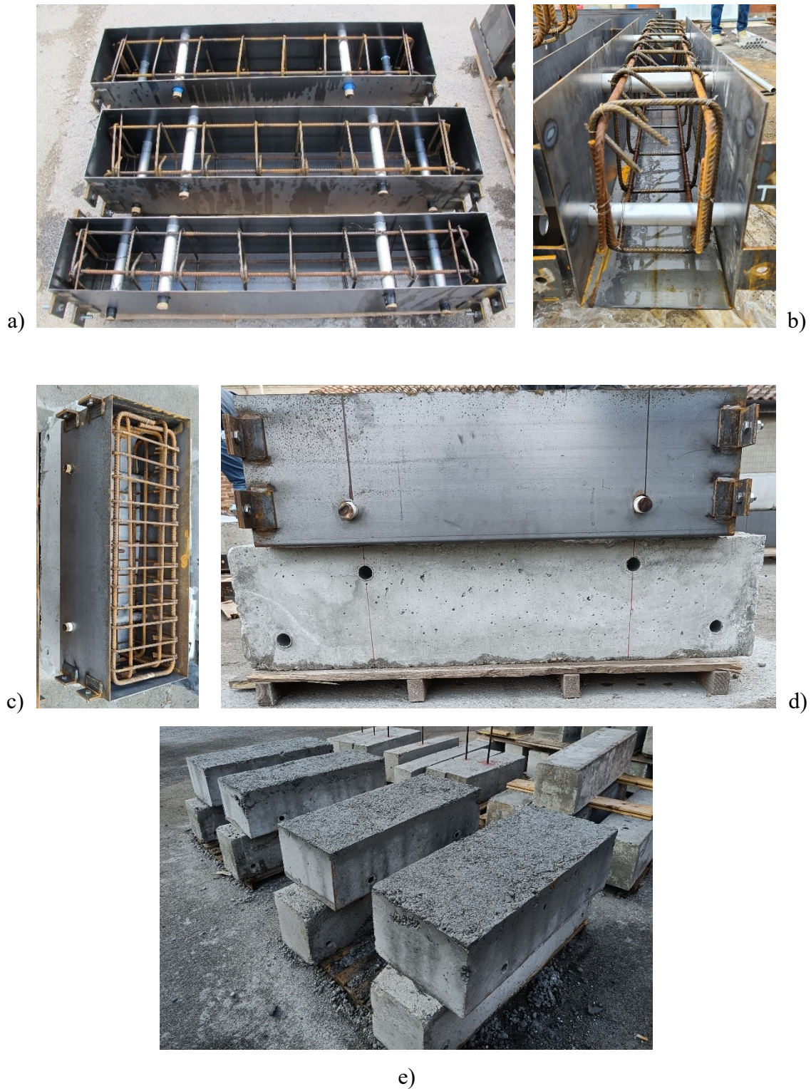
Fig. 7-5. Prove di taglio ortogonale. Fase 1: realizzazione del cassero in acciaio e collocamento della gabbia di armatura del cordolo (a,b). Fase 3: realizzazione del cassero in acciaio e collocamento della gabbia di armatura del trasverso; posizionamento del cordolo (c,d). Maturazione dei provini (e).
