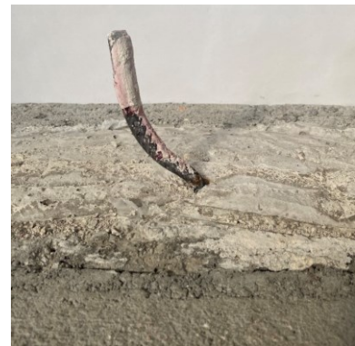
Fig. 6-13. Prove di taglio parallelo monotono su tasselli: modalità di rottura per provini con sezione trasversale B = 250 mm e tassello d = 16 mm
