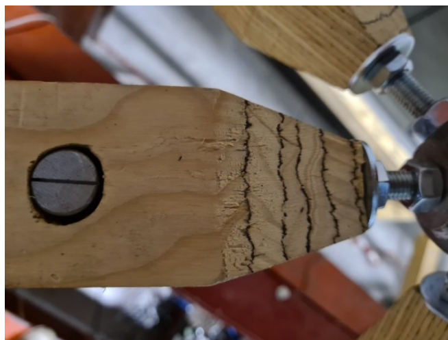
Fig. 4-33 Prototipo ligneo 2. Modalità di trasferimento del carico.
