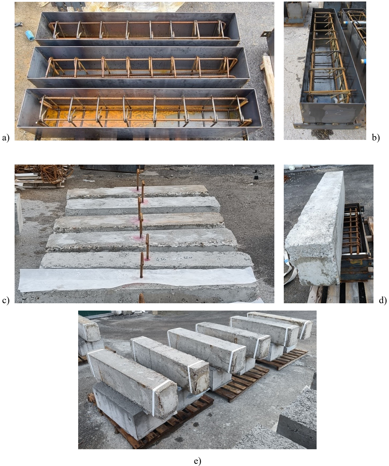
Fig. 6-6. Prove di taglio parallelo. Fase 1: realizzazione del cassero in acciaio e collocamento della gabbia di armatura del cordolo (a,b). Fase 2: realizzazione del tassello post-inserito nel cordolo (c). Fase 3: realizzazione del cassero in acciaio e collocamento della gabbia di armatura del traverso; posizionamento del cordolo (d). Maturazione dei provini (e).
