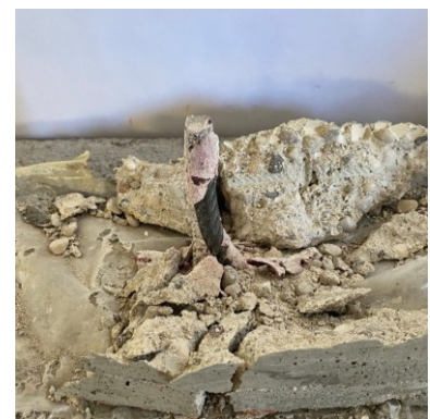
Fig. 6-11. Prove di taglio parallelo monotono su tasselli: modalità di rottura per provini con sezione trasversale B = 200 mm e tassello d = 16 mm
