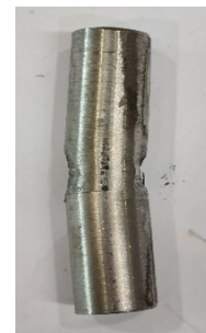
Fig. 4-4 Tipologia A con svaso. Modalità di rottura in trazione per provini: in LVL di abete (a, b, c) e in LVL di faggio (d, e, f). Connettori S355 al termine della prova (g,h,i). Distanza longitudinale dalla testa del provino a_1 = 100 mm (a, d, g), 150 mm (b, e, h) e 150 mm (c, f, i). Sezione trasversale B = 60 mm (a, b), 80 mm (c, d) e 100 mm (e, f).
