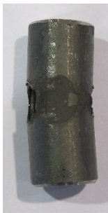
Fig. 4-4 Tipologia A con svaso. Modalità di rottura in trazione per provini: in LVL di abete (a, b, c) e in LVL di faggio (d, e, f). Connettori S355 al termine della prova (g,h,i). Distanza longitudinale dalla testa del provino a_1 = 100 mm (a, d, g), 150 mm (b, e, h) e 150 mm (c, f, i). Sezione trasversale B = 60 mm (a, b), 80 mm (c, d) e 100 mm (e, f).
