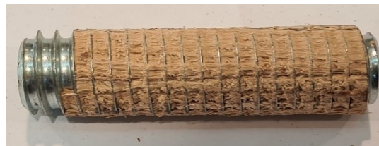
Fig. 3-5 Insetto avvitato ( D = 25 mm) al termine della prova.
