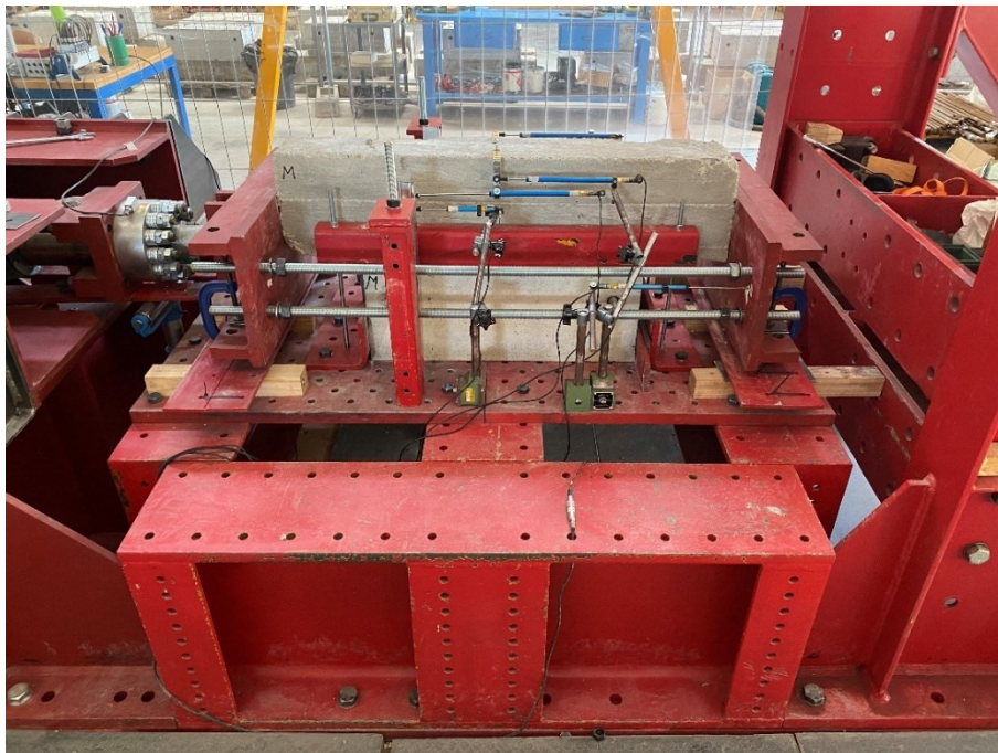
Fig. 6-2. Prove di taglio parallelo: Setup di prova
