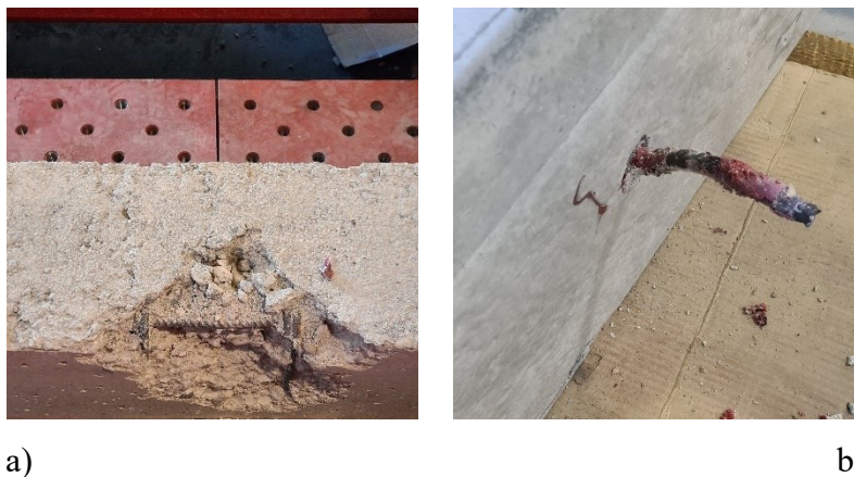
Fig. 7-7. Prove di taglio parallelo monotono su tasselli: modalità di rottura per provini con sezione trasversale B = 200 mm e tassello d = 12 mm
