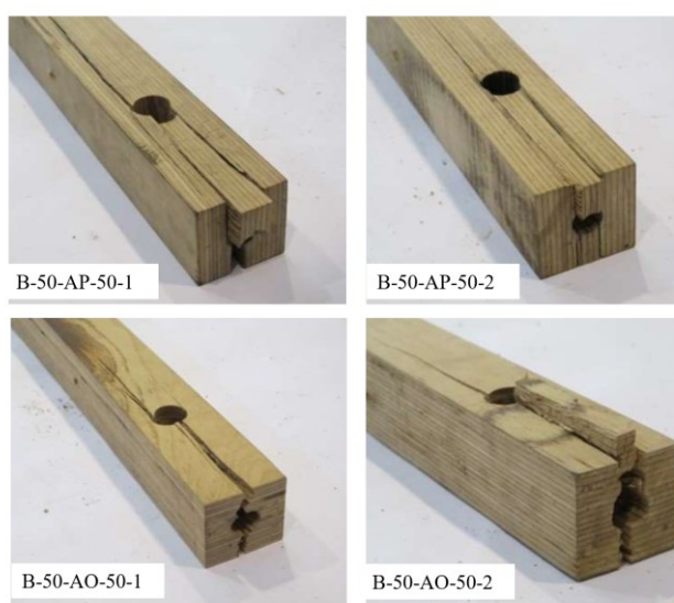
Fig. 1-15. Test preliminari: Modalità di rottura in trazione su unioni di tipologia A
