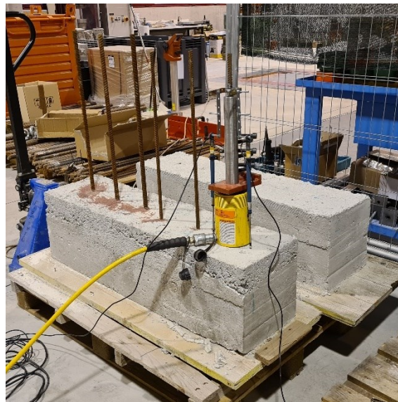
Fig. 5-1 Prove di pull-out per la determinazione della tensione di aderenza tra il tassello e il calcestruzzo
