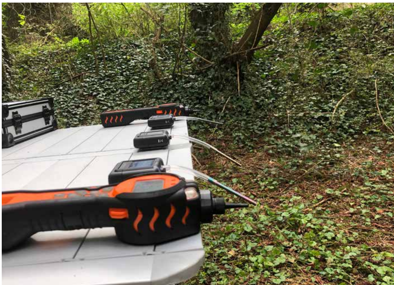
Figura 3 - Strumenti per il campionamento dell'aria dei siti forestali – ph Francesco Meneguzzo
