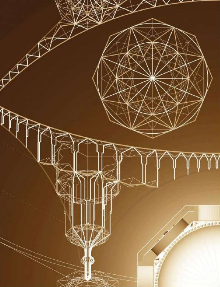
03 Elaborazione sintetica della ricostruzione geometrica del pennacchio principale della moschea Selimiye attraverso transizioni a muqarnas
