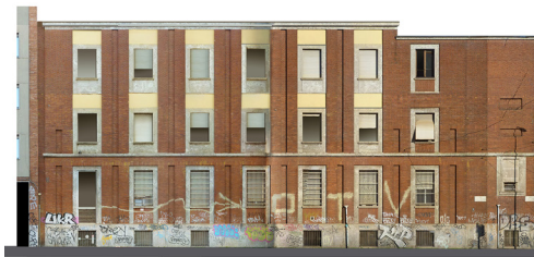
Fig. 8. Centrale telefonica di Città Studi, prospetto su via Spinoza. Sopra: primo progetto del 1939; sotto: ortofoto elaborata con fotogrammetria digitale (elaborazione grafica degli autori).
