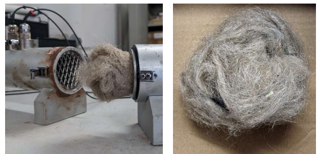
Figura 1 – Fibre sciolte di juta e loro installazione nel tubo ad onde piane
