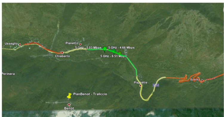
Fig. 4.6: Copertura lungo il percorso a con il sistema White-Fi
