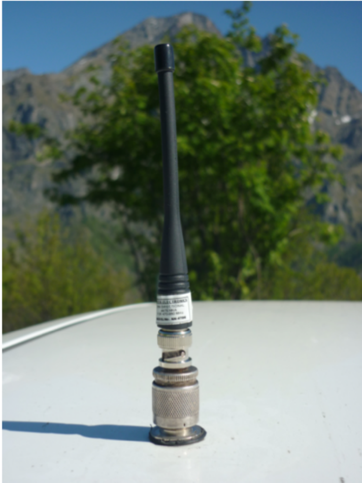
Fig. 4.4: Antenna ricevente a 763 MHz
